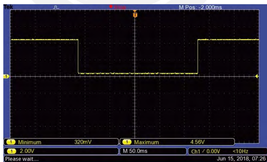
Figura 60: Señal en baja del TIMER555 después de 3 segundos. Fuente: Elaboración propia.
