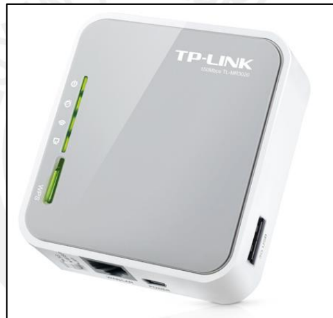
Figura 17. Router marca TP-Link [50] .
