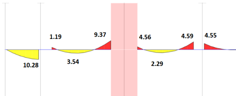
Figura 16. Momentos flectores M_u por cargas de gravedad (ton.m)
