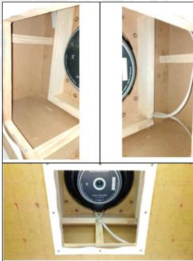
Figura 37. Vistas internas del gabinete acústico después del refuerzo de su estructura.
