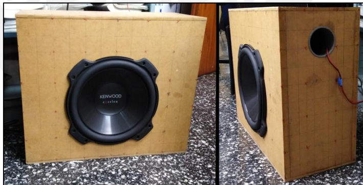
Figura 35. Implementación final del gabinete acústico.
