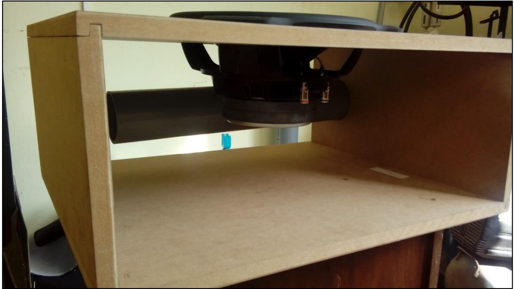
Figura 34. Vista lejana del altavoz junto al ducto dentro del gabinete acústico.
