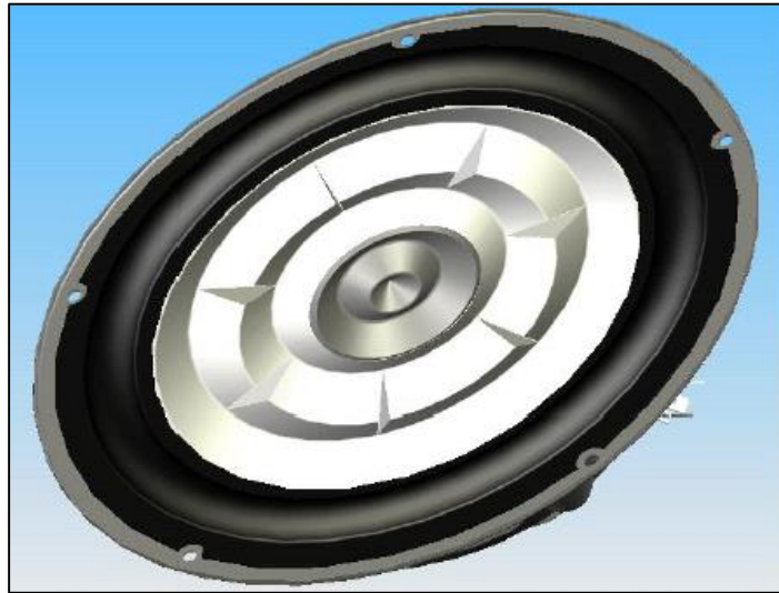
Figura 1. Vista delantera de un modelo a computadora del diseño del altavoz con diafragma plano propuesto por Fruttup. Se puede apreciar la estructura de sostén (líneas transversales a las circunferencias) [10].
