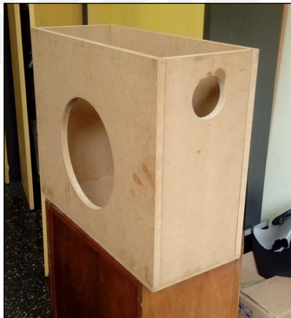
Figura 32. Caras del gabinete acústico con los cortes para el altavoz y el ducto de PVC.
