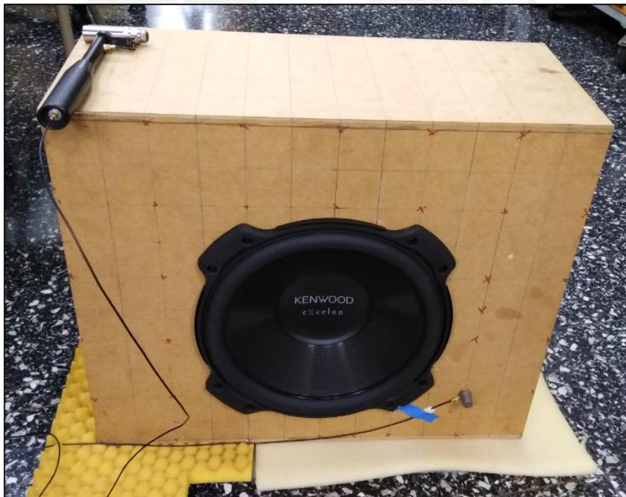
Figura 69. Imagen del setup para el análisis modal del subwoofer.
