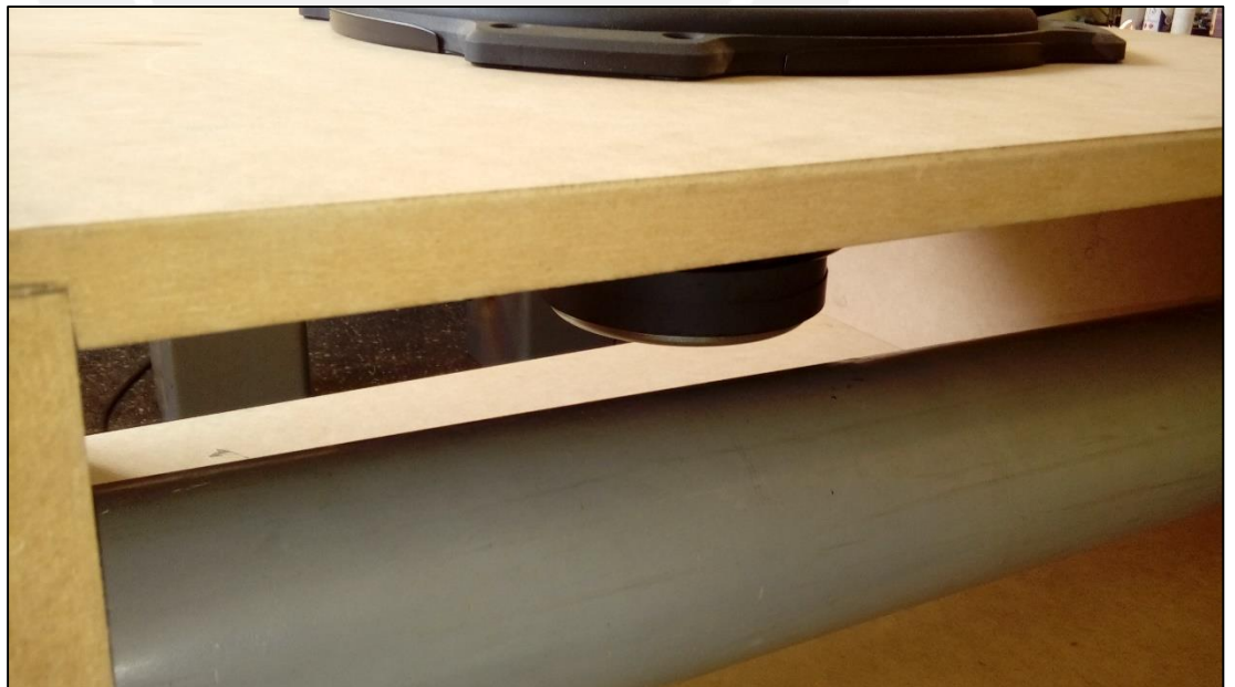
Figura 33. Vista cercana del altavoz junto al ducto dentro del gabinete acústico.
