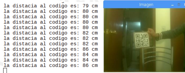
Figura 4.8 medición distancia con imagen 320x240
