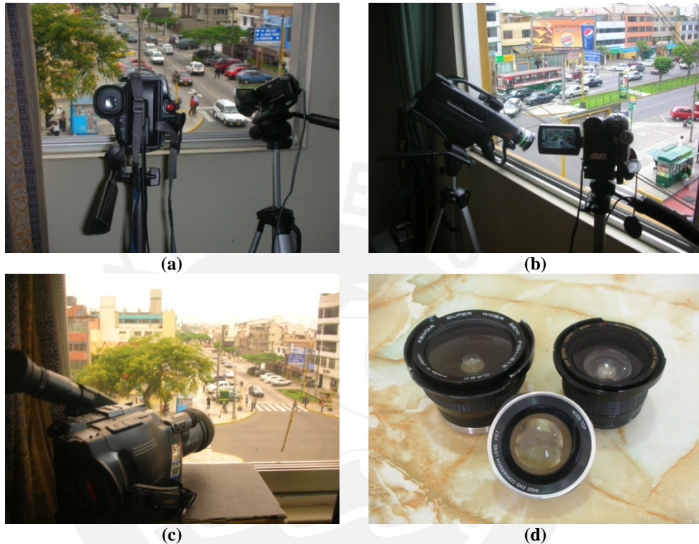
Figura 19. Equipos de filmación empleados en la recolección de datos: (a) cámaras 1 y 2, (b) cámaras 3 y 4, (c) cámara 5 y (d) lentes gran angular y ojo de pez
