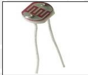
Figura 2.6: LDR (Tomado de la hoja de datos del LDR 3190, SUNROM)
