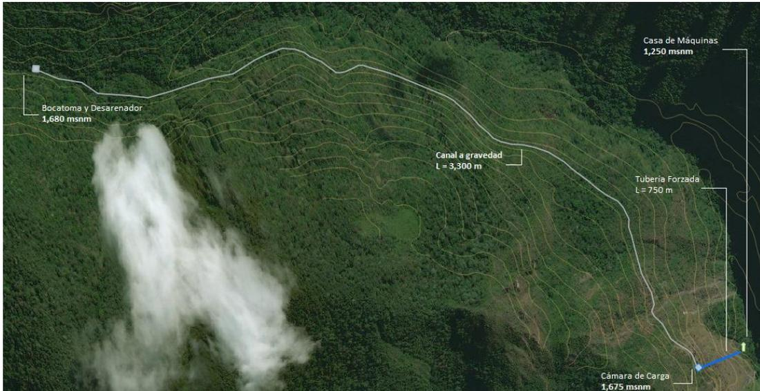
Figura 8.1 Planta de la Alternativa A-1, proyecto C.H. FELFE.
