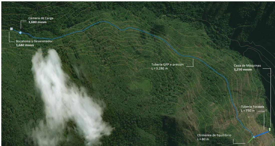
Figura 8.3 Planta de la Alternativa A-2, proyecto C.H. FELFE.
