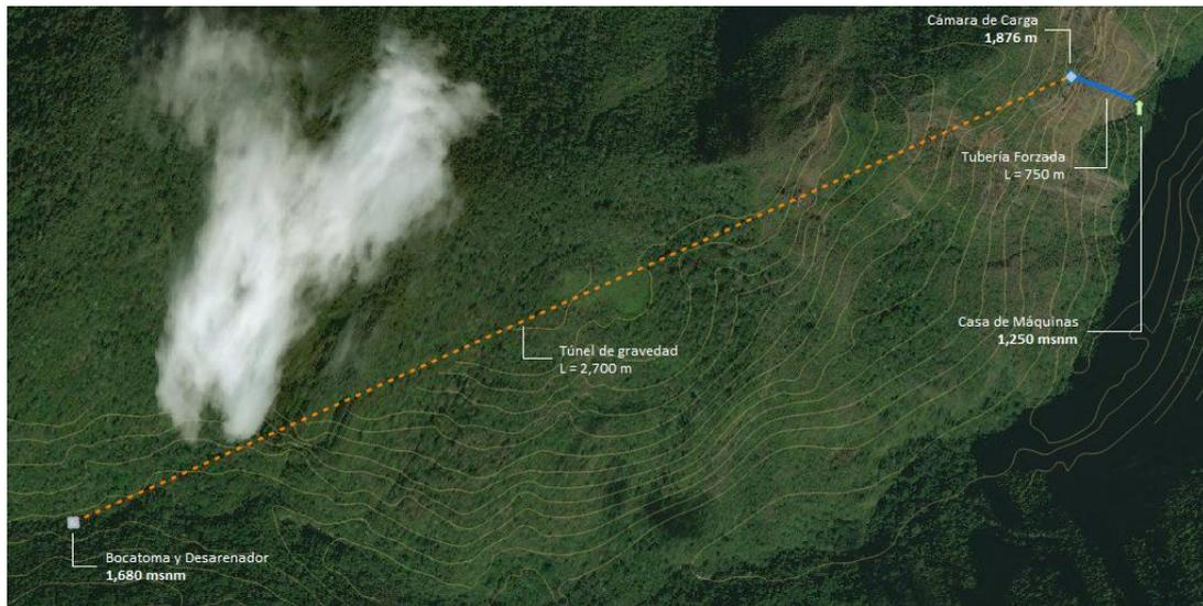
Figura 8.5 Planta de la Alternativa B-1, proyecto C.H. FELFE.
