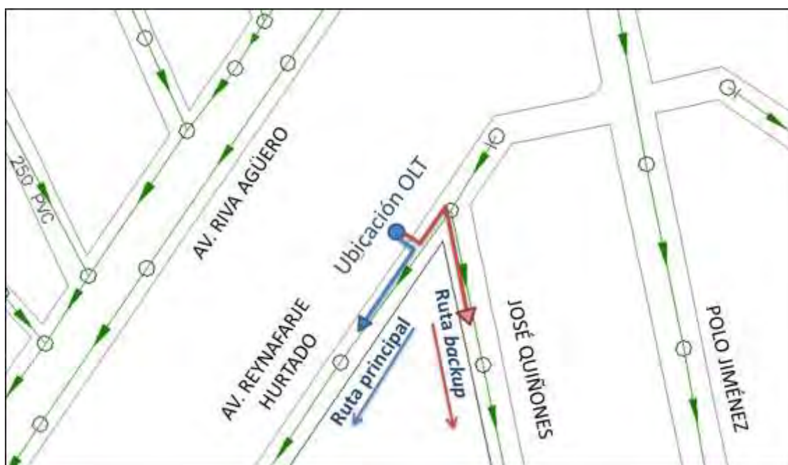
FIGURA 3 - 6: Inicio de rutas principal y backup a través de la red de alcantarillado [Elaboración propia]
