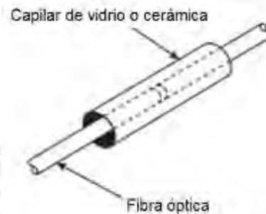
FIGURA 2 - 3: Técnica de empalme mecánico basada en el empleo de un tubo rígido [28] [29] [Elaboración propia]
