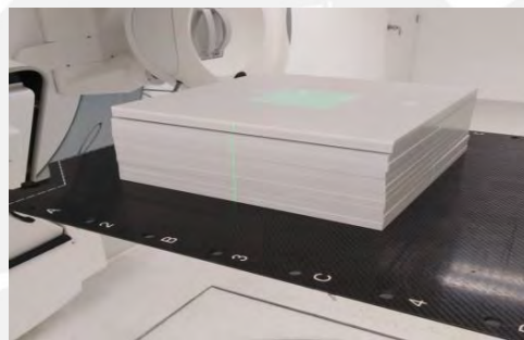
Figura 4.1: Procedimiento para hallar el factor de calibración de los dosímetros estimulados ópticamente.
