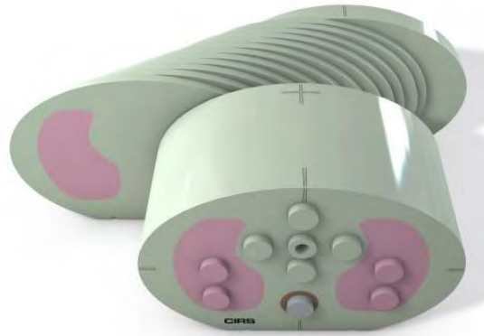
Figura 2.15: Fantoma CIRS de prueba para radioterapia / pulmón / tórax. Modelo 002LFC
