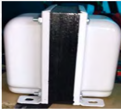
Figura 3.13: Transformador de Aislamiento Adquirido
