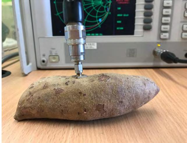
**Figura 3.1. Conexión de los instrumentos para la sustracción de los coeficientes de reflexión en una muestra.**
