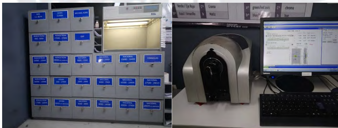
Figura 37. Revisiones en cámara especial de luz y uso de espectrofotómetro. Imágenes brindadas por Industrias Printex S.A.C.
