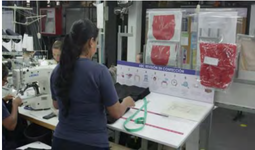
Figura 40. Módulo de inspección de prendas de la estación confección. Imagen brindada por Industrias Printex S.A.C.
