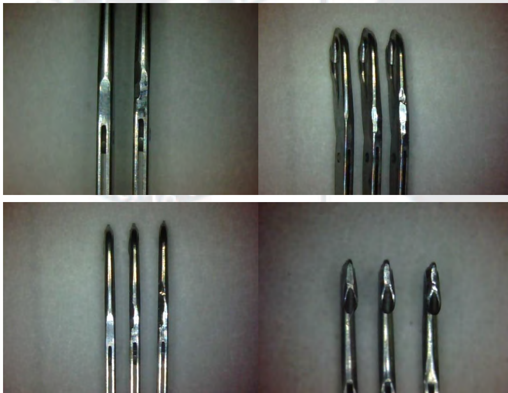
Figura 56. Agujas de tejido en buen estado y desgastadas. Las agujas de la izquierda son nuevas, las de la derecha presentan desgaste y no deben ser utilizadas. Imágenes tomadas con un microscopio digital. Imágenes brindadas por industrias Printex S.A.C.
