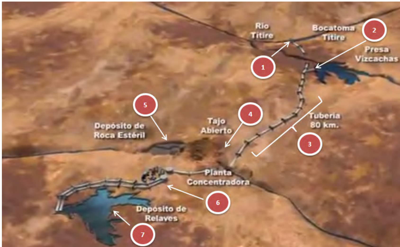
Figura 15. Sistema de abastecimiento hídrico del Proyecto Anglo American Quellaveco. Tomado de “QuellavecoTV” (Febrero, 2010).
