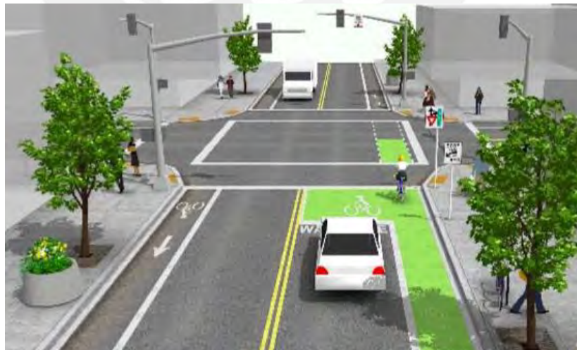
Figura 23: Las cajas para bicicletas en un cruce con semáforos
