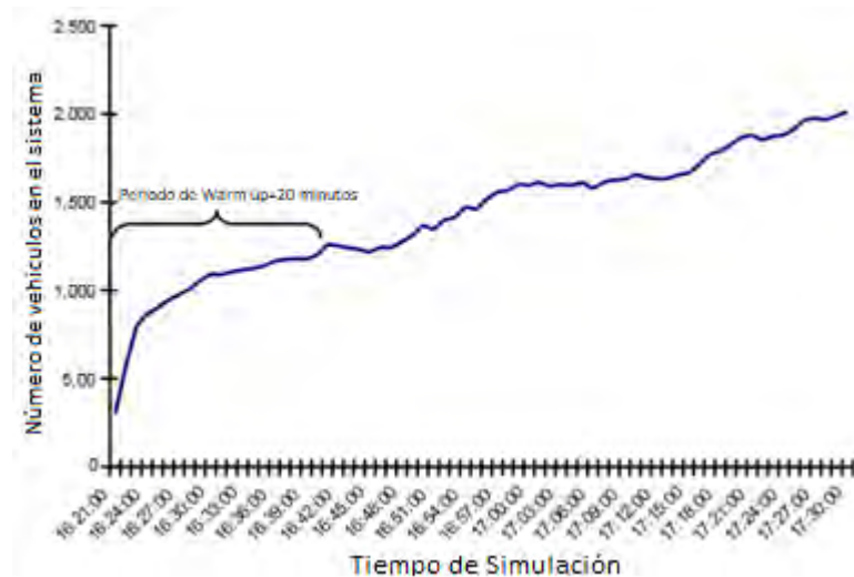
Figura 24: Ejemplo de periodo de estabilización o warm up
