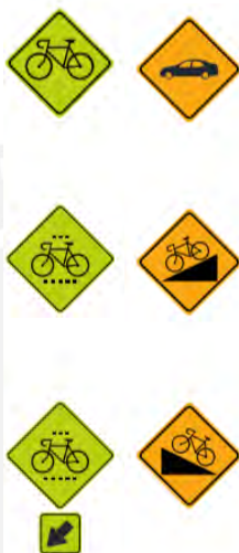
Figura 20: Señales preventivas orientadas a la seguridad del ciclista
