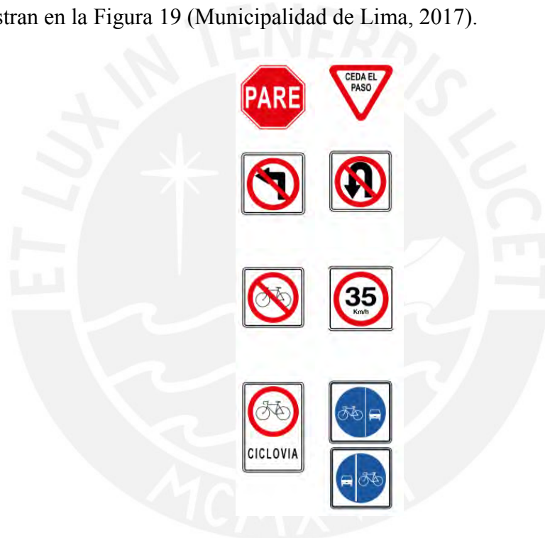
Figura 19: Señales reglamentarias aplicables en infraestructura ciclovial
