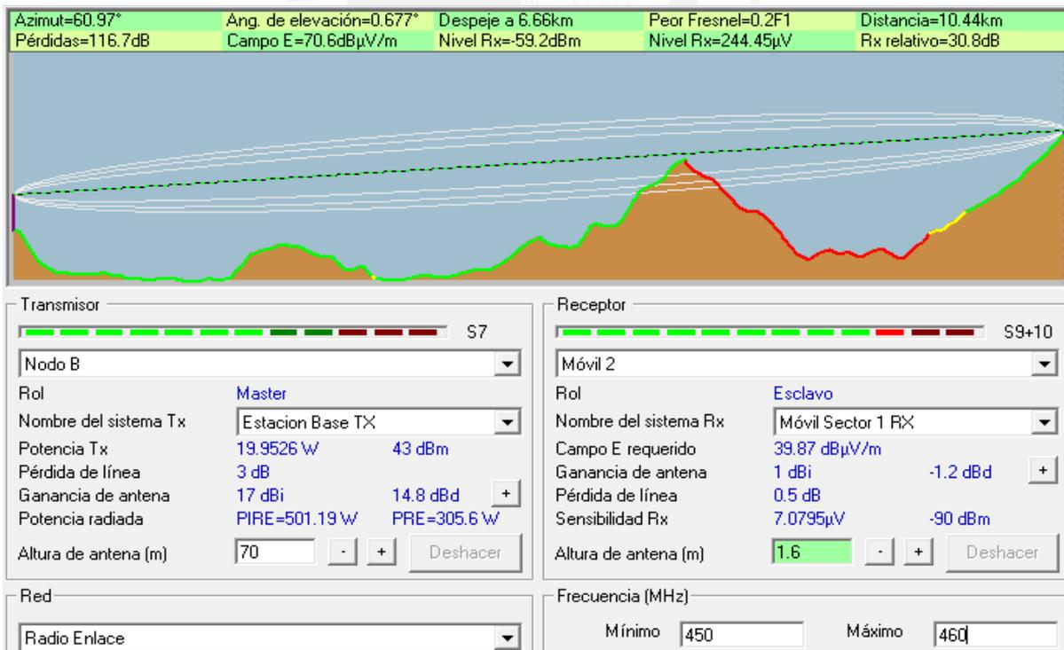
Figura 32: Perfil de enlace NodoB-Móvil2 en la banda de 450 MHz
