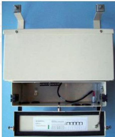
**Figura 41: Caja de protección para exteriores [45]**
