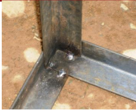
Fig. 3.1: Unión de perfiles entre caras sin destajo.
