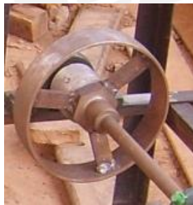
Fig. 3.7: Vista de la polea hechiza para faja plana.
