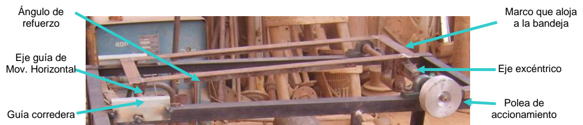
Fig. 3.5: Vista de componentes del alimentador vibratorio.
