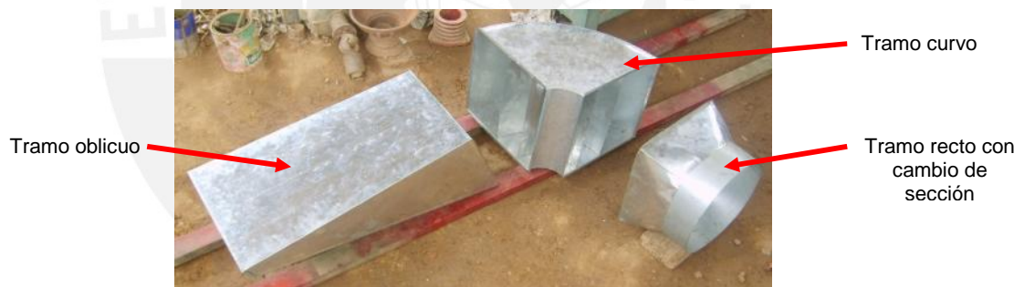
Fig. 3.9: Vista de los tramos del ducto.
