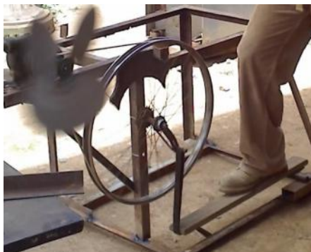
Fig. 2.21: Mecanismo casero de 4 barras
