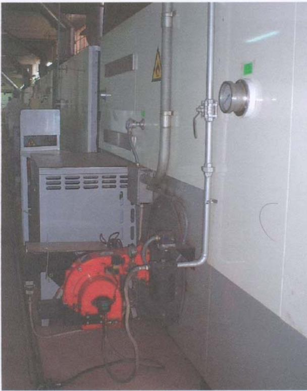
Horneo continuo de fuego indirecto para horneado de panetones. La capacidad del horno puede ser calculada del actual consumo de combustible, la cual es de 5 galones de Diesel 2 por hora, por cada quemador.
