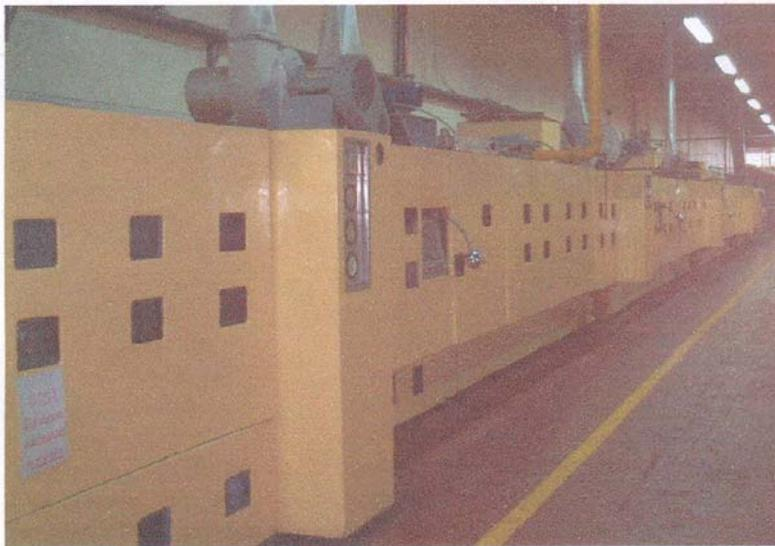
Horno continuo para horneado de galletas. La capacidad del horno puede ser deducida del consumo actual de combustible: 40 gal LPG/hr
