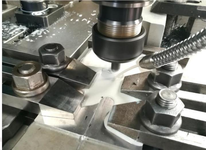
**Figura 5. Fijación de placas para soldaduras realizadas bajo alimentación continua de líquido refrigerante**
