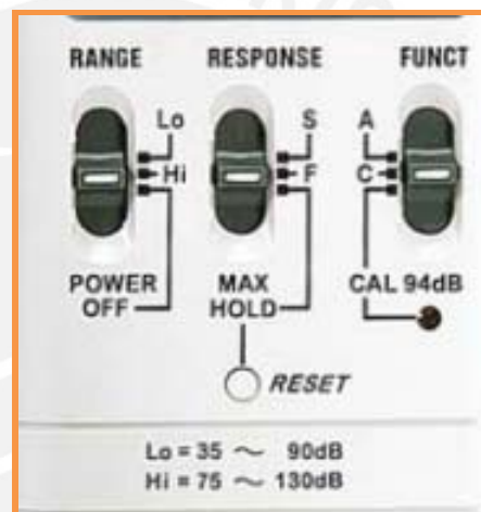
Fig 3.2 Botones de configuración de Sonómetro Modelo 407735 Fuente: EXTECH Instruments Disponible en: http://extech.com
