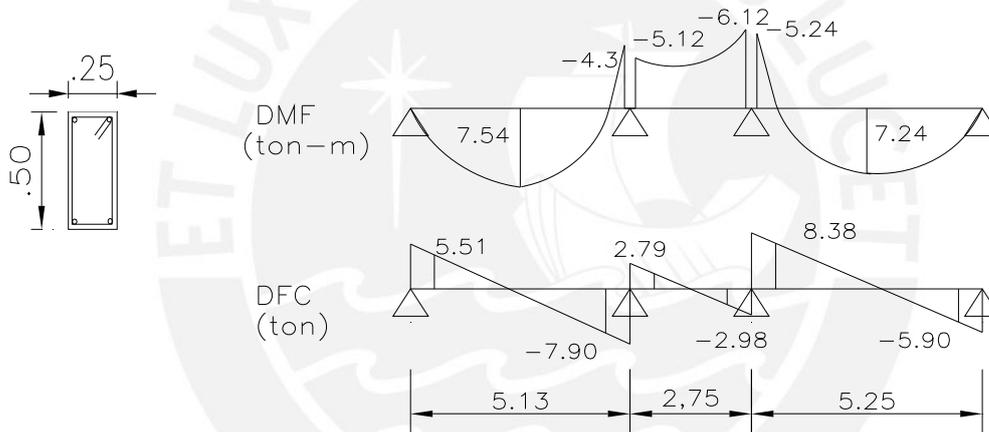
**Fig.6.2 Diagrama de Fuerza Cortante y Momento Flector de Viga V-09**
