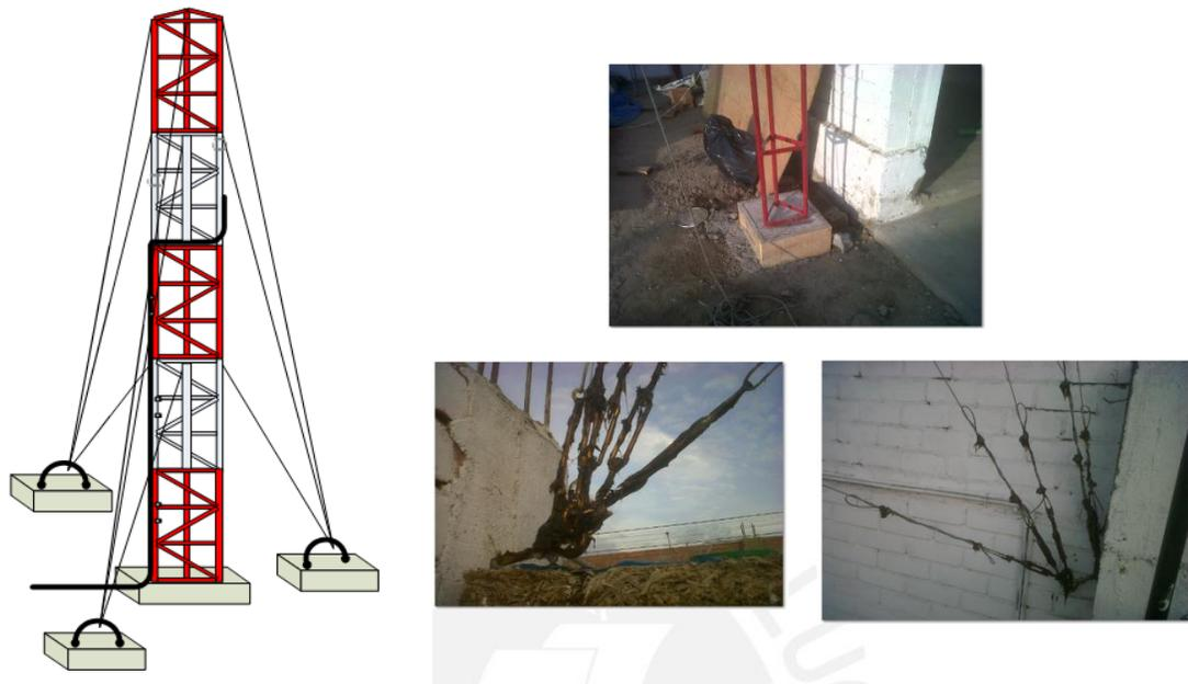
**Figura 5-4: Torre Ventada: Base y Vientos**
