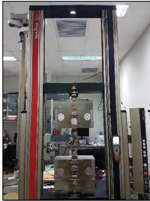
Figura 2.14. Máquina de tracción universal Zwick/Roell Z050
