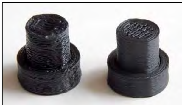
Figura 2.7. Diferentes espesores de capa para una misma pieza [33]
