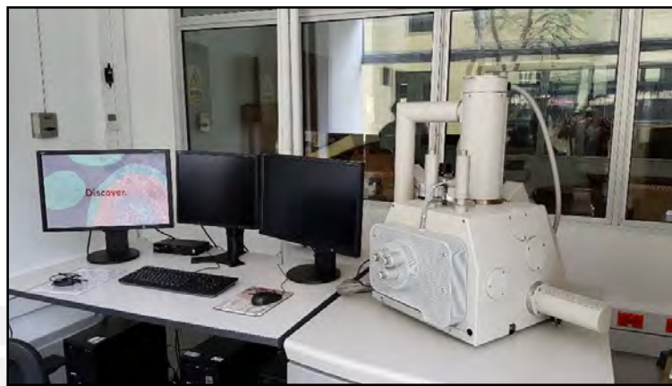
Figura 2.20. Microscopio Electrónico de Barrido Quanta 650
