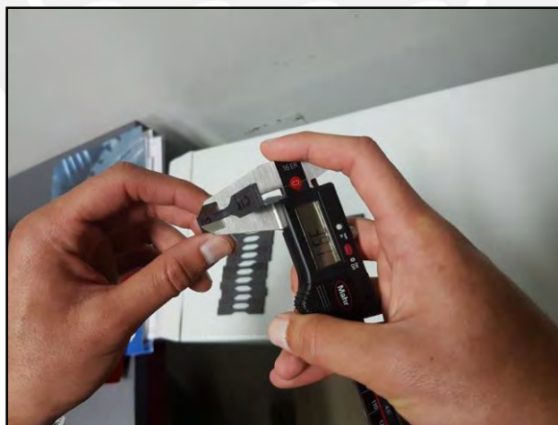
Figura 2.12. Medición de espesor de las muestras de tracción
