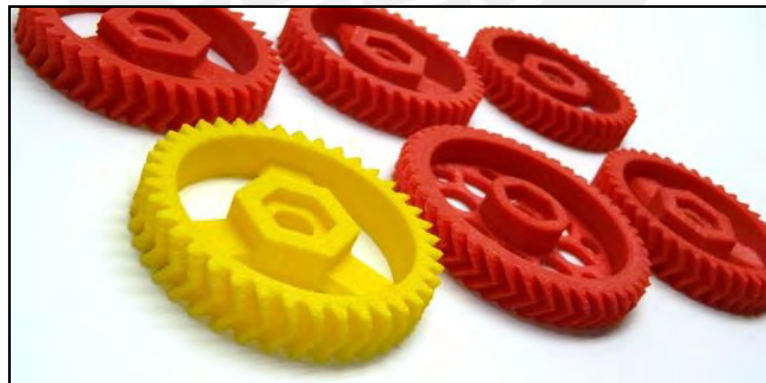
Figura 1.13. Engranajes impresos con ABS [18]
