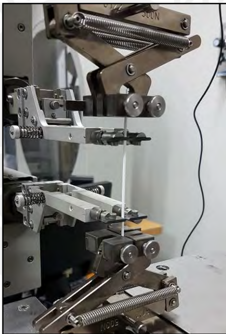
Figura 2.17. Ensayo de tracción de filamentos
