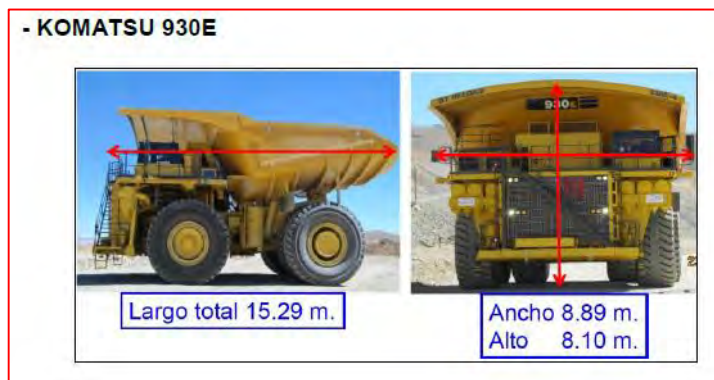
Figura 5.27 Dimensiones Camión Komatsu 930-E
