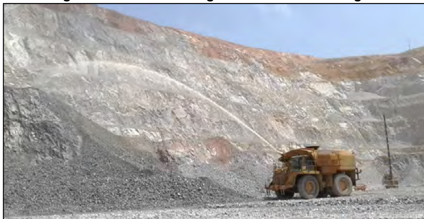
Figura 4.24 Cisternas regando un frente de carguío
