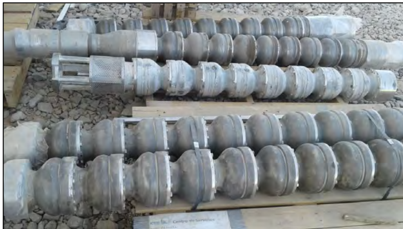
Figura 4.21 Bombas sumergibles verticales en almacén Pit Dewatering
