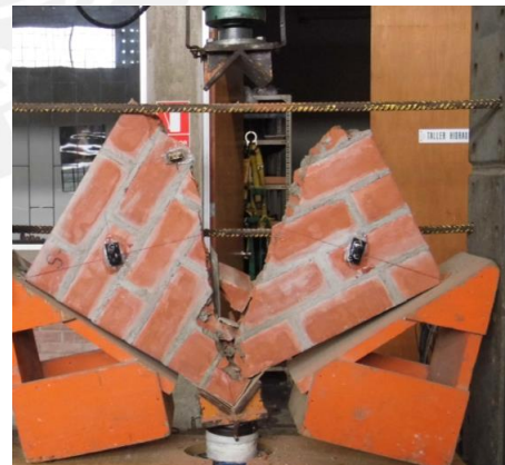
b) Falla por tracción diagonal en el murete 2
