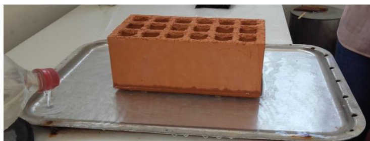
Figura 2.9 Ladrillo colocado en la lámina de agua de 3 mm
