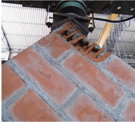
c) Falla local por aplastamiento en el murete 3
