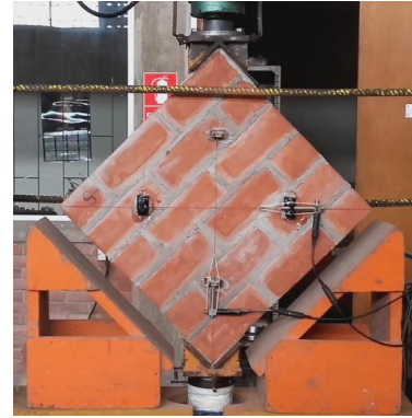
b) Murete colocado en la máquina de ensayo
