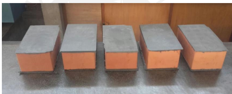
a) Capping colocado a los ladrillos
