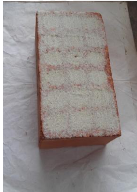
a) Arena de Ottawa colocada en los orificios
