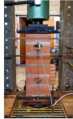
b) Instrumentación local colocada en la pila.
