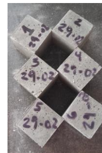
e) Cubos de mortero al día siguiente después de su vaciado
