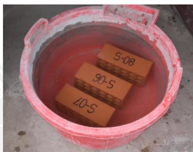
Figura 2.10 Ladrillos colocados en agua luego de haberse enfriado
