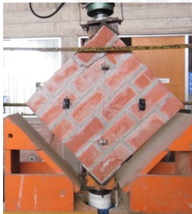
a) Falla local por aplastamiento en el murete 1
