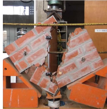
d) Falla por tracción diagonal en el murete 4
