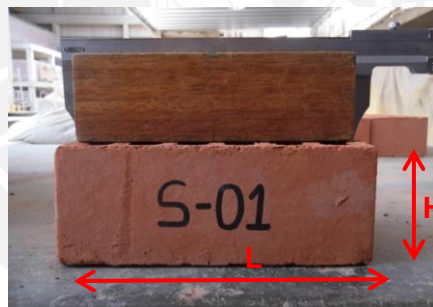
Figura 2.6 Medición del largo de la unidad
