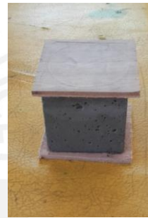
c) Colocación del capping de triplay
