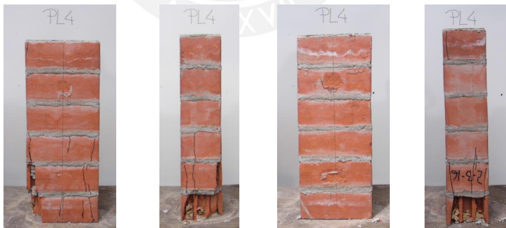
d) Fallas producidas en las caras de la pila 4. En la primera, segunda y última foto se observan un aplastamiento en la base inferior.
