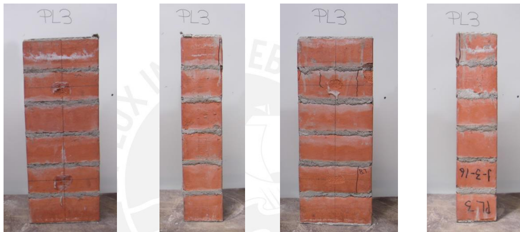
c) Fallas producidas en las caras de la pila 3. Segunda y cuarta foto: se observa una lámina de la unidad partida. Tercera foto: se observan algunas fallas.
