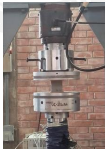
d) Ensayo de compresión de probetas cúbicas de mortero en la máquina universal
