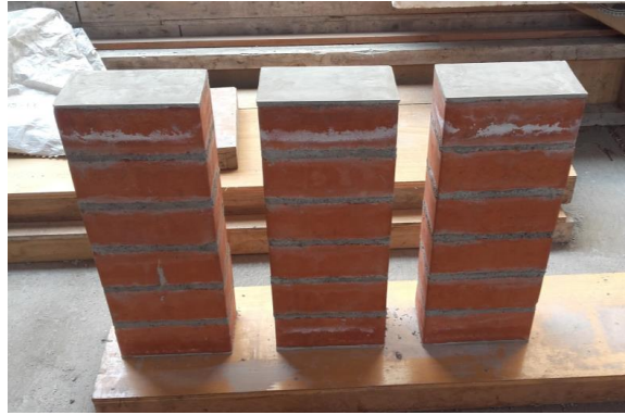
d) Pilas con capping colocado en la base superior
