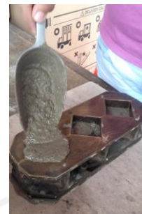
b) Colocación de la segunda capa de mortero
