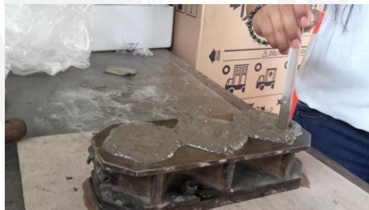
c) Compactación de la mezcla con un pistón de plástico
