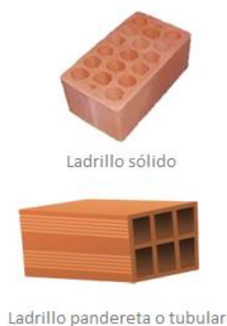
Figura 1.2 Comparación gráfica entre un ladrillo sólido (18 huecos) y otro tubular. (Adaptado de Aceros Arequipa, s.f.)
