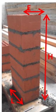
a) Medidas de las pilas: H=600\text{mm} , L=230\text{mm} , E=130\text{mm}
