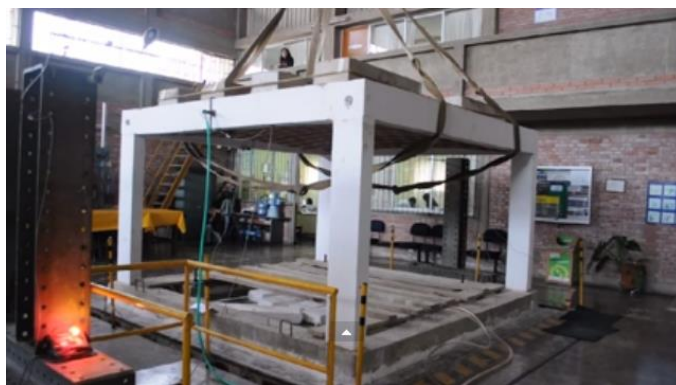
Figura 1.4 Ensayo de un entrepiso de bóvedas de doble curva en una mesa vibradora. (Cisneros, 2011)
