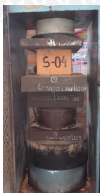
b) Ensayo de compresión en el ladrillo
