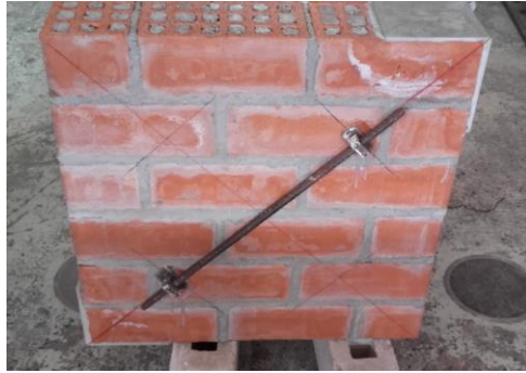
a) Colocación de las bases de la instrumentación vertical.
