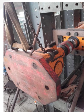
Figura 6.3 Actuador ubicado a la altura de la viga solera
