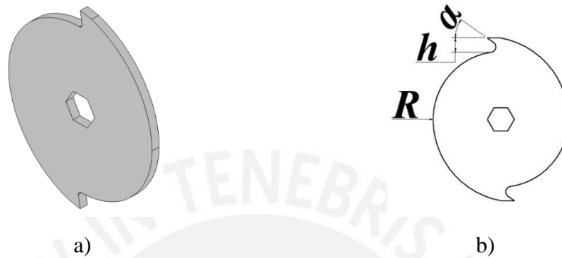
Figura 4.5 Herramienta de corte; a) forma, b) parámetros
