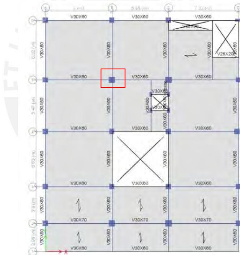
Figura 7.5. Diseño en planta de columna interior.
