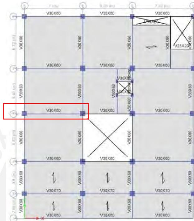
**Figura 7.4. Diseño en planta de Viga de 30x60 en pisos superiores.**
