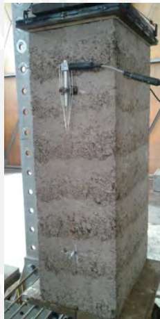
Figura 1.1. Prisma de tapial con sensores LVDT instalados en las caras de menor dimensión.
