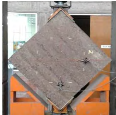
Figura 1.2. Murete de tapial con sensores LVDT instalados a compresión y a tracción, en una de las caras del murete.
