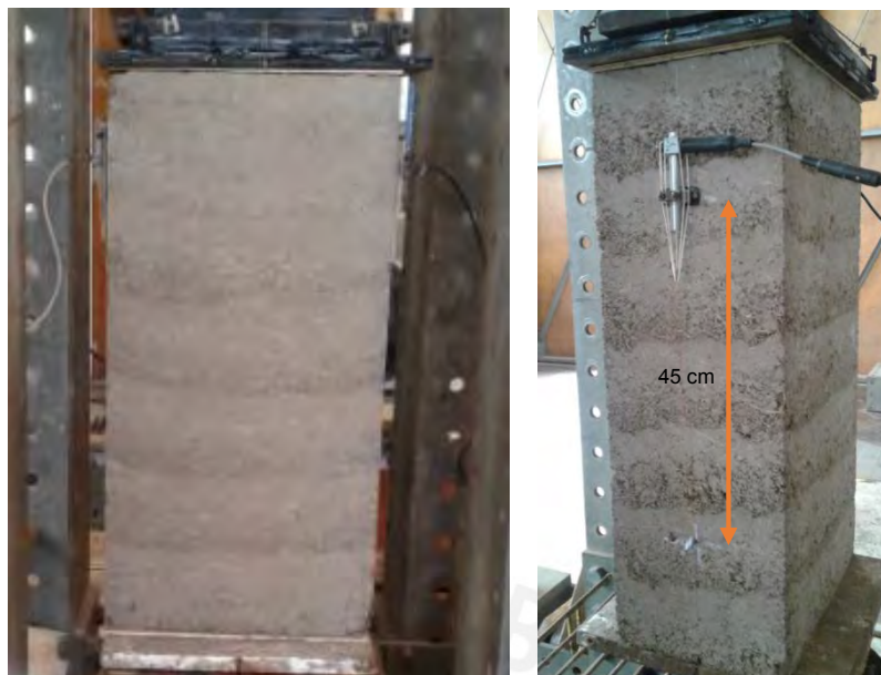
Figura 3.9. Colocación de los LVDT en las caras de menor dimensión
