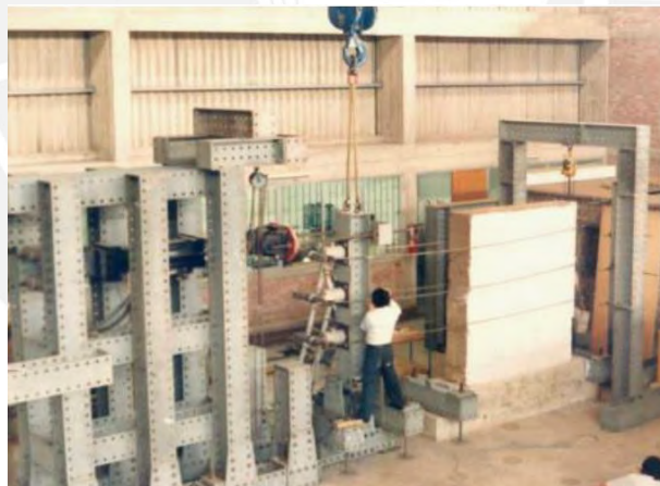
Figura 2.15. Ensayo Estático en Muros de Tapial (ININVI, 1989)
