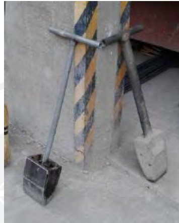
Figura 2.7. Pisones de base en forma de cuña. A la izquierda, de metal y la derecha, de concreto.
