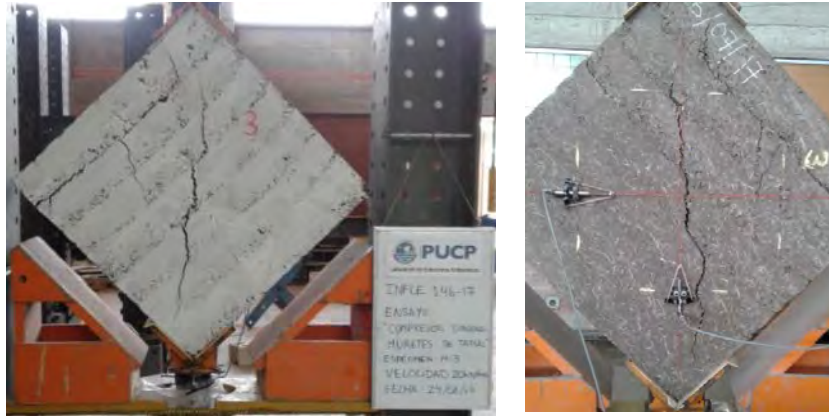
Figura A.5. Tamaño y forma de falla del murete 3 antes del retiro de los LVDT.
