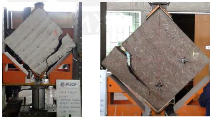
Figura A.1. Tamaño y forma de falla del murete 1 antes del retiro de los LVDT.
