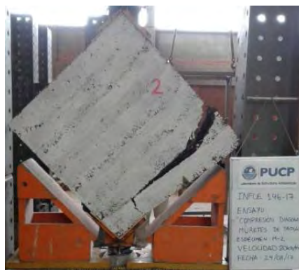
Figura A.3. Tamaño y forma de falla del murete 2 antes del retiro de los LVDT.
