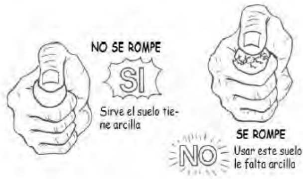
Figura 2.4. Prueba de “presencia de arcilla” o “resistencia seca” (Ministerio de Vivienda, 2017)
