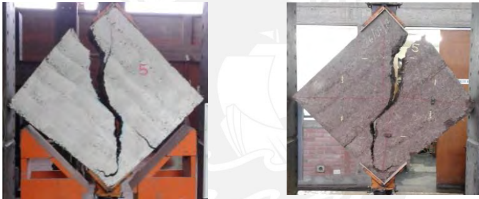
Figura A.9. Tamaño y forma de falla del murete 5 después del retiro de los LVDT.
