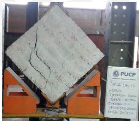
Figura A.6. Tamaño y forma de falla del murete 4 antes del retiro de los LVDT.
