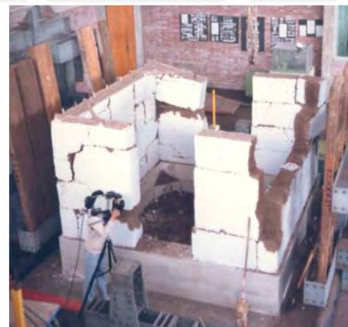
Figura 2.17. Falla del medio módulo 1 (sin solera) y conservación del medio módulo 2 (ININVI, 1989)
