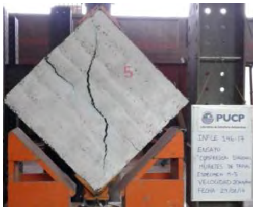
Figura A.8. Tamaño y forma de falla del murete 5 antes del retiro de los LVDT.
