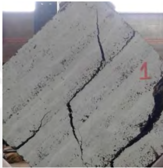
Figura A.2. Tamaño y forma de falla del murete 1 después del retiro de los LVDT.
