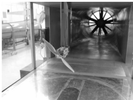
Figura 1.20 Configuración experimental en túnel de viento - UIUC. (Fuente: Brandt & Selig, 2011: pág. 2)
