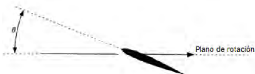
Figura 1.10 Ángulo de paso ( \theta ) (Fuente: Adaptado de Leishman, 2006: pág. 116)
