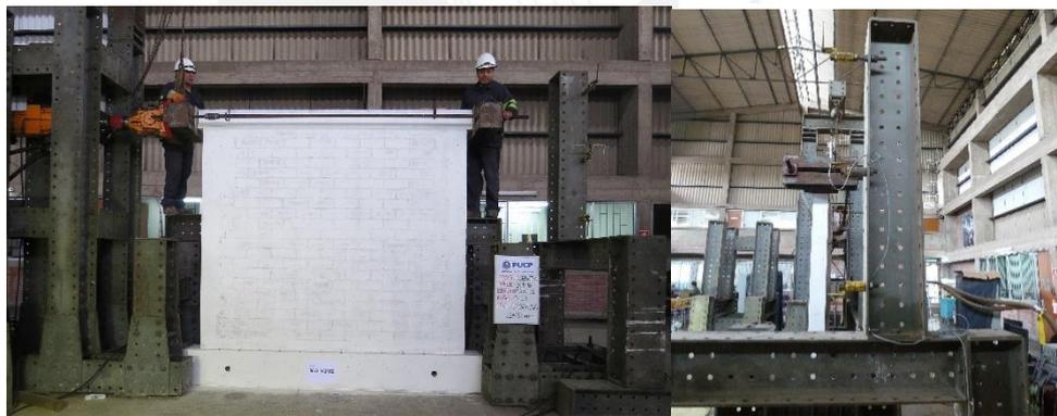
Figura 4.3 Colocación del actuador hidráulico para aplicación de la fuerza horizontal
