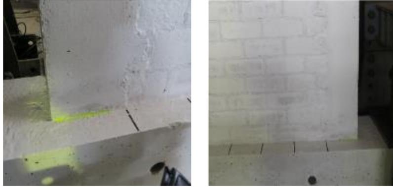
Figura 4.7 Fisuras en los extremos inferiores de las columnas
