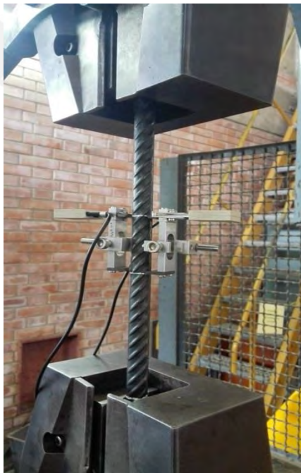
Fig. 42. Maquina universal y dispositivo de medición local
