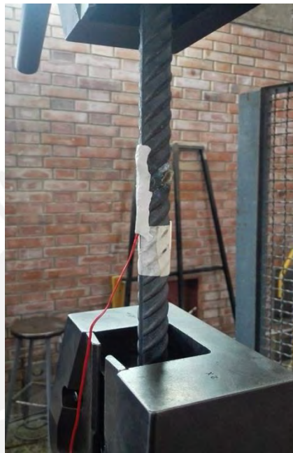
Fig. 43. Varilla con strain gauge para medir deformación local
