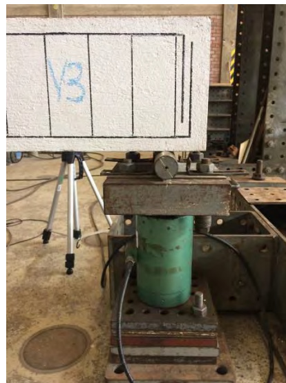
Fig. 49 – Celda de carga en el apoyo derecho
