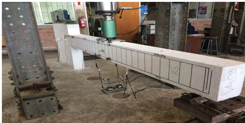
Fig. 50 y 51 – Vigas preparadas para el ensayo (VA01 y VA02 respectivamente)
