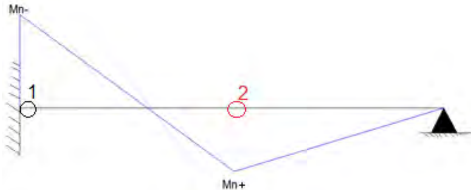
Fig. 21 – Mecanismo plástico de falla VA01, VA02 y VA03
