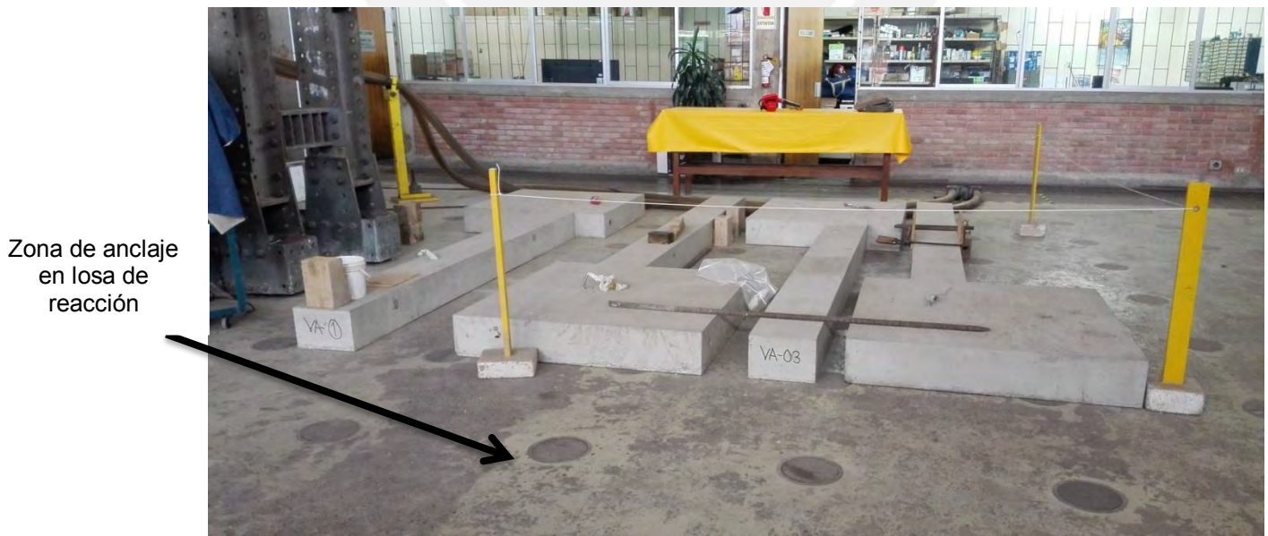
Figura 18– Vigas a ensayar y ubicación de puntos de anclaje en la losa de reacción
