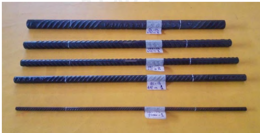
Fig. 41. Barras de acero corrugado para ensayos
