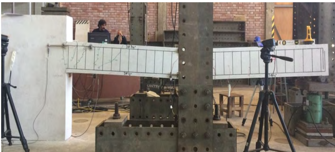
Fig. 61 – Deformada final en viga VB04
