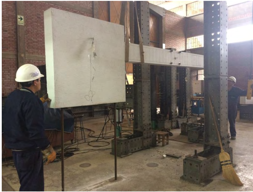
Fig. 48 – Izado y colocación en zona de anclaje
