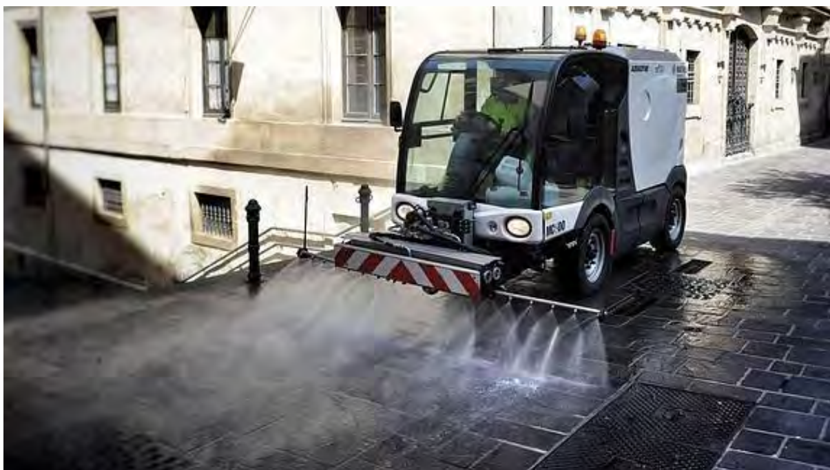
Figura E1: Vehículos con motor eléctrico para limpieza de calles Citymaster 600. Barredora y vehículo multifuncional. Recuperado de http://www.hako.es/wp-content/uploads/2017/07/citymaster-600-catalogo-.pdf
