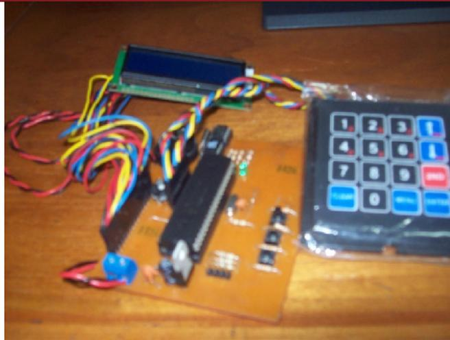
**Figura 4.2:** Circuito de control del seguidor solar
