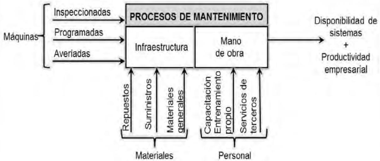
Figura 9. Proceso de mantenimiento como proceso productivo.
