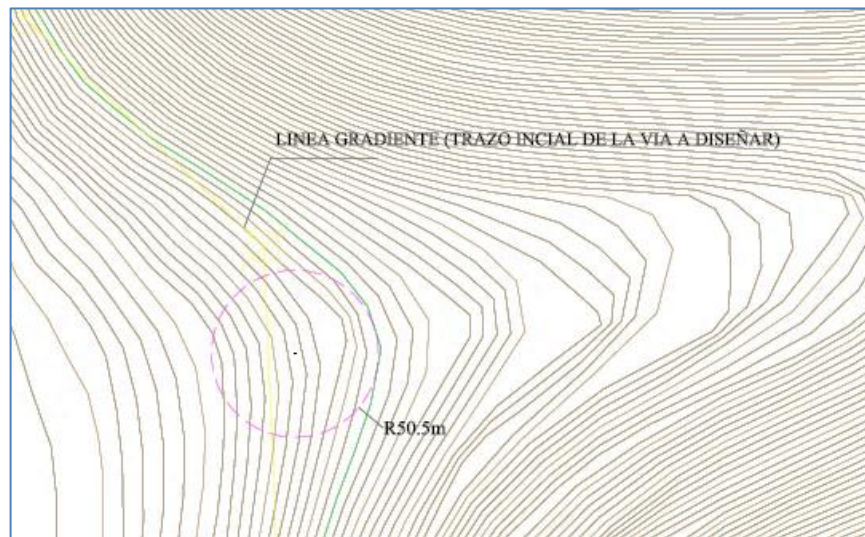
Figura N° 38: Radio mínimo aproximado a partir de las curvas de nivel
