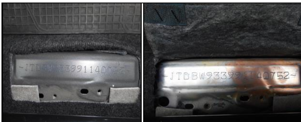
Figura 5: Vehículos con códigos de identificación similares (izquierda es original y el siguiente regrabado en vehículo “clonado” con marcación serial original modificada).
