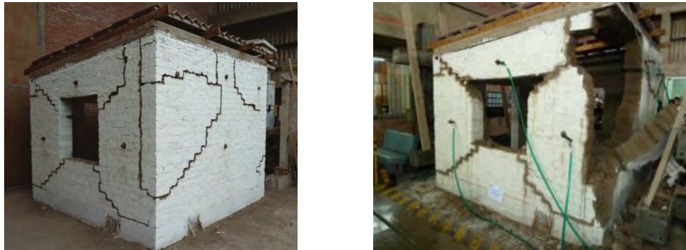
(a) Modelo reparado antes del ensayo (b) Colapso de modelo luego de ensayo
