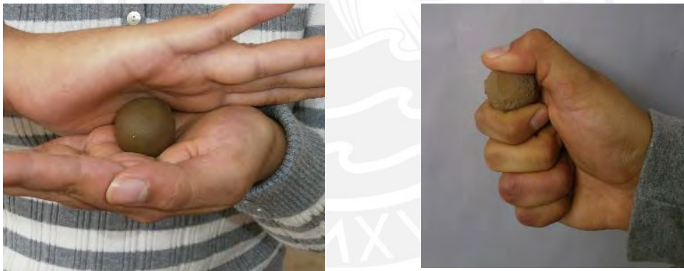
(a) Formación de bolita de tierra (b) Presionar con el dedo pulgar contra el índice
