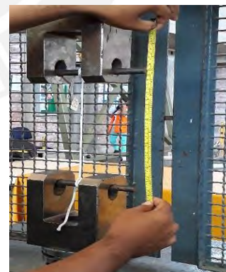
(b) Ensayo de tracción en MTS
