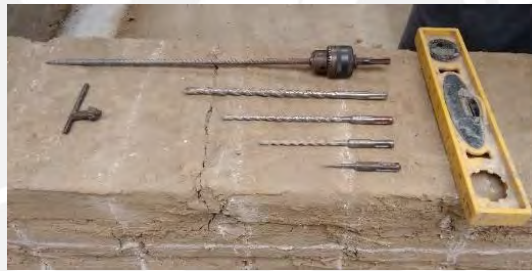
Figura 4.5. Brocas usadas como herramientas de perforación
