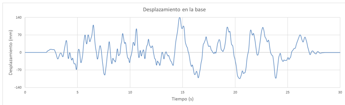
Figura 2: Desplazamiento del simulador sísmico ( D_{max} = 140mm )
