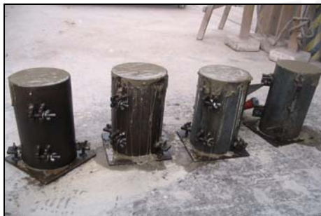
Fig. 3.8. Preparación de probetas estándar y curado 28 días.
