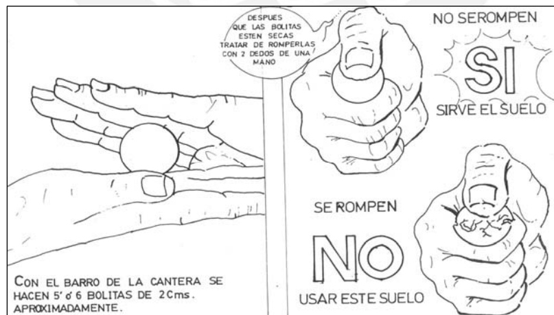
Fig. 2.1 Prueba común para ver si la tierra es apta para la construcción de adobes
