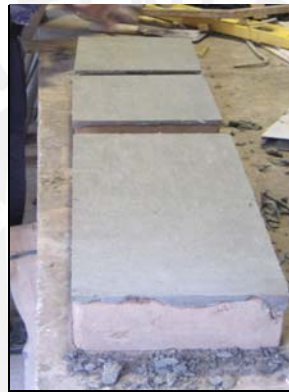
Fig. 3.3 Colocación del capping.
