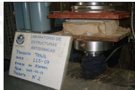
Fig. 3.4 Ensayo de compresión en medias unidades de adobe.
