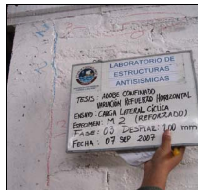
Fig.5.21. Primera fisura que pasa el refuerzo horizontal.
