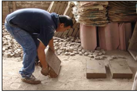
Fig. 2.10. Desmolde del adobe
