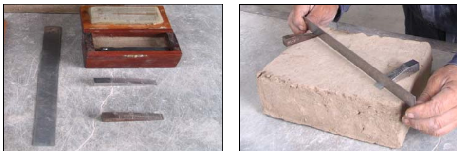
Fig. 3.2 Instrumentos y ensayo de alabeo de unidades.
