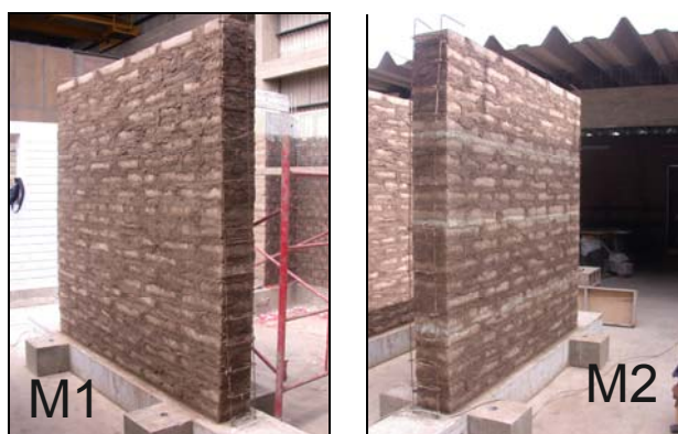
Fig. 4.9. Finalización del asentado de adobes en muros M1 y M2
