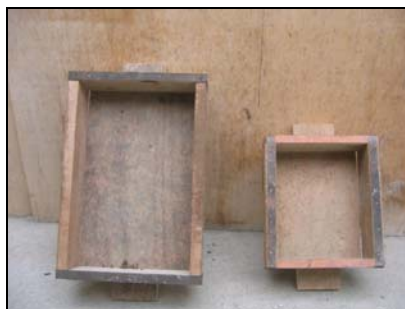
Fig. 2.3 Gaveras para la fabricación de adobes.
