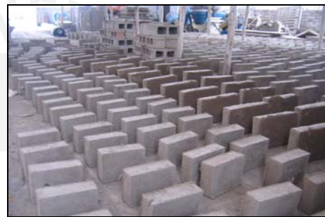
Fig. 2.11. Primera y segunda etapa de secado en un área techada.
