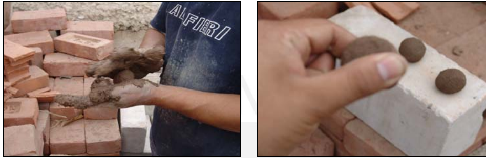
Fig. 2.2. Prueba para selección de suelo.
