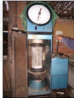
Fig. 3.9. Colocación de capping y ensayo de probetas.
