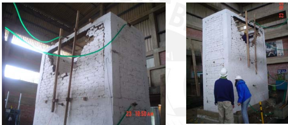
Fig. 1.4. Ensayo sísmico de un módulo de 2 pisos (Ref.7). Falla en forma de “V” en un muro del segundo piso por acción sísmica transversal al plano.
