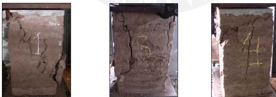
Fig. 3.6. Formas de falla en pilas de adobe.
