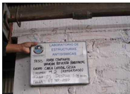
Foto 5.28 Fisura en la conexión solera-columna izquierda.
