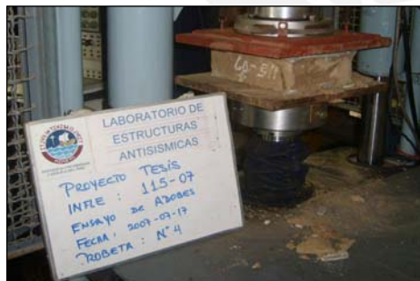
Fig. 3.4 Ensayo de compresión en medias unidades de adobe.
