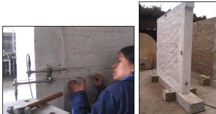
Fig. 5.4. Instalación de transductores eléctricos de desplazamientos (LVDT).
