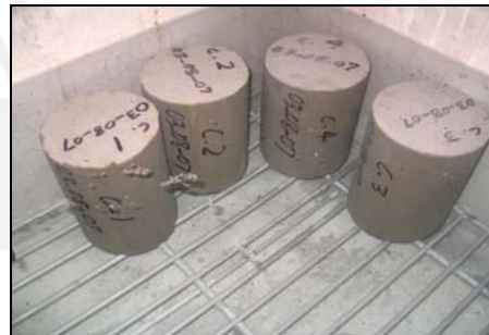
Fig. 3.8. Preparación de probetas estándar y curado 28 días.
