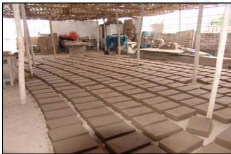
Fig. 2.11. Primera y segunda etapa de secado en un área techada.
