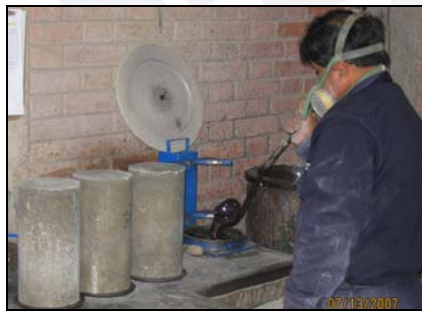
Fig. 3.9. Colocación de capping y ensayo de probetas.
