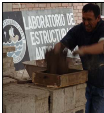
Fig. 2.8. Lanzado de barro al molde
