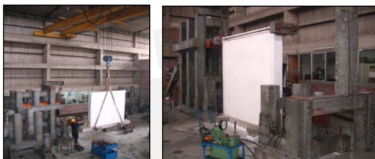
Fig. 5.2. Traslado del muro.
