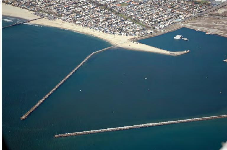
Figura 2.4: Captura de imagen de espigones usados para medir la tasa de transporte litoral de sedimentos.. Adaptado de Sadura (2017).
