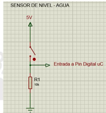
Fig. 3.6.4.2.2: Diagrama esquemático del circuito detector de nivel de agua.
