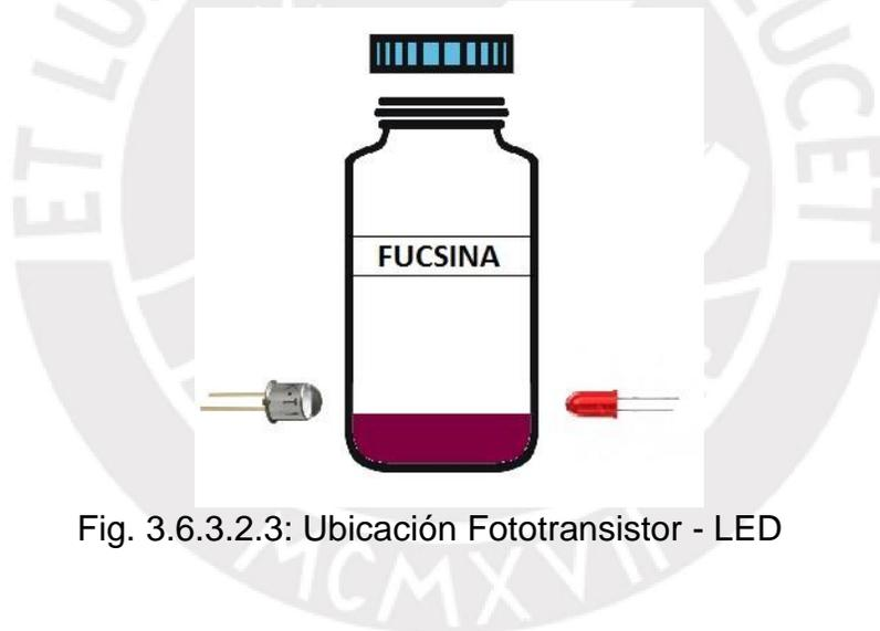
Fig. 3.6.3.2.3: Ubicación Fototransistor - LED
