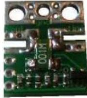
Fig. 4.8 sensor de voltaje y corriente Attopilot 180A [26]
