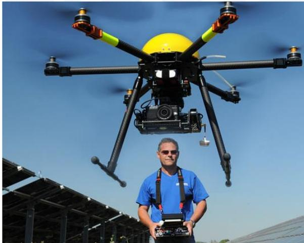
Fig. 2.1 Multirotor G4 drone con cámara de imagen térmica [7]
