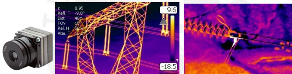
Fig. 4.6 De izquierda a derecha: cámara quark 2 [13], imagen termográfica de torre de transmisión [22] imagen termográfica de componente a punto de fallar [23]
