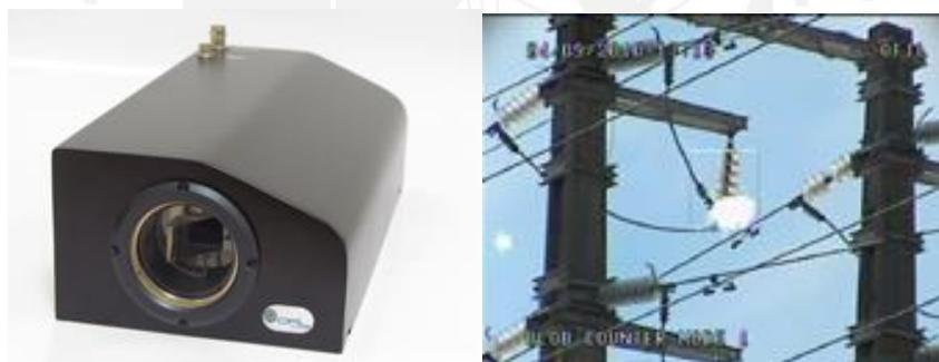
Fig. 2.7 DayCor® ROMpact (izquierda) [15] imagen ultravioleta de cámaras DayCor [16] (derecha)
