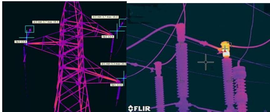
Fig. 4.41 Imagen termográfica con una sola temperatura (distribución normal) [41] (izq.)
