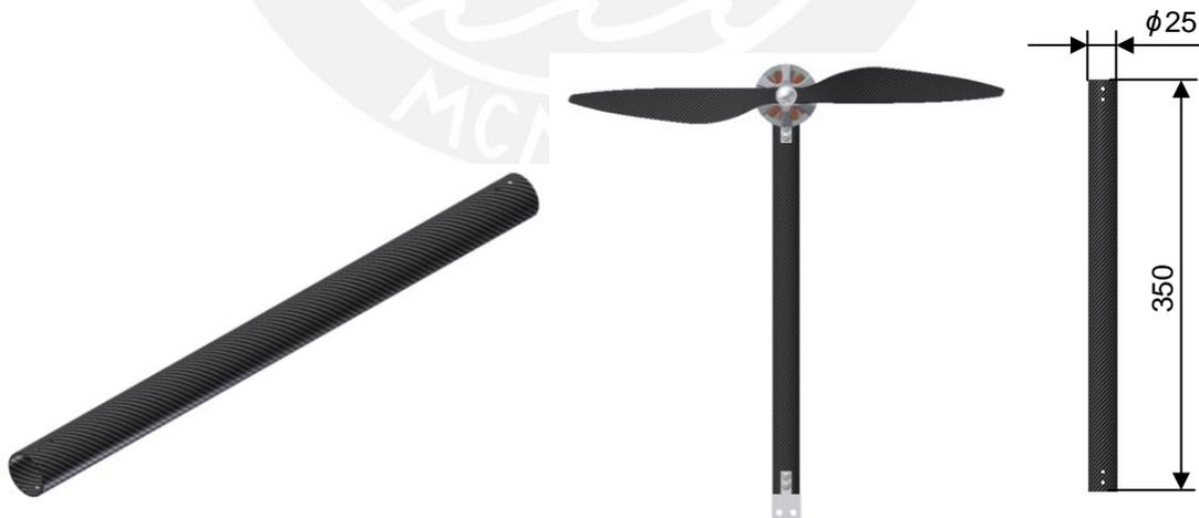
Fig. 4.26 Vista isométrica del brazo. Fuente: elaboración propia.
