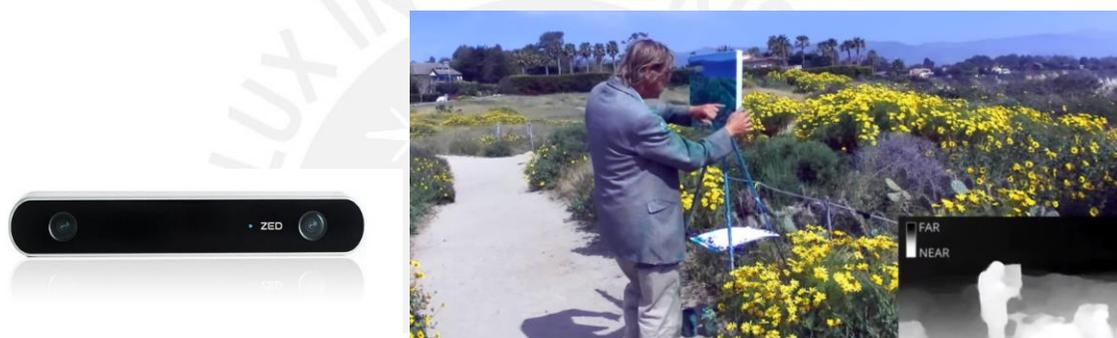
Fig. 4.5 Cámara ZED [18] (izquierda) imagen mostrada por visor de profundidad [19] (derecha)
