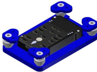
Fig. 4.31 Controlador de vuelo fijado a su montura antivibración. Fuente: elaboración propia.
