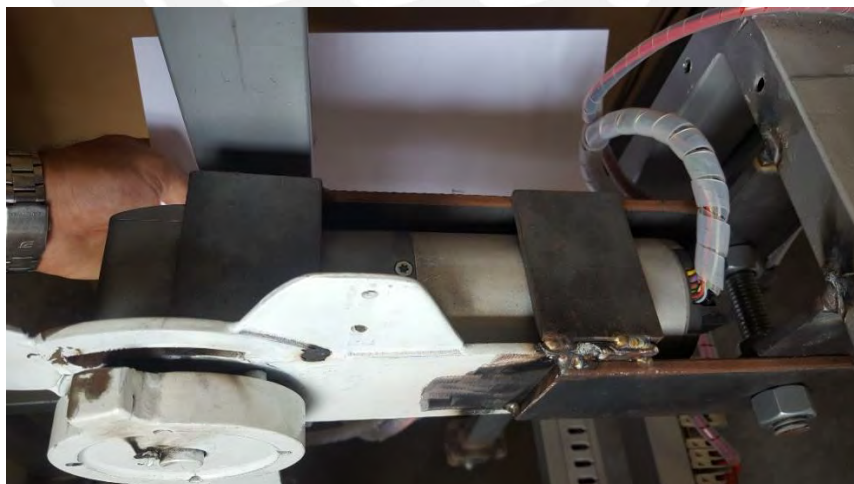
Figura 2.10: Estructura que mantiene en su lugar el servomotor de la articulación de la cadera y permite su rotación alrededor del apoyo de la derecha, la articulación del otro lado del Exoesqueleto es idéntica a esta.
