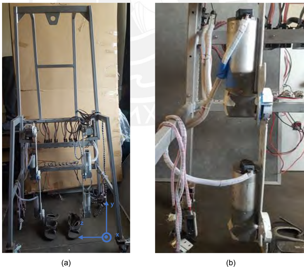
Figura 1.7: a) vista frontal del Exoesqueleto PUCP, b) vista de los servomotores que mueven los eslabones del exoesqueleto.
