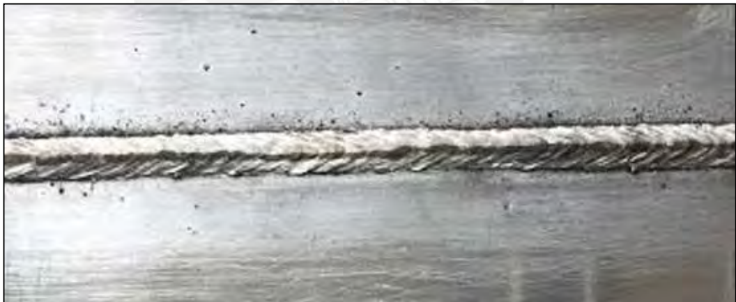
Figura 3.1. Cordón de soldadura del AA6063-T6.
