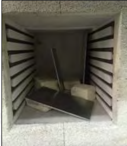
Figura 2.5. Planchas ubicadas en el interior del horno para el tratamiento de solubilizado.
