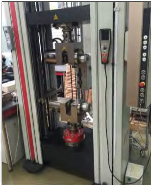
Figura 2.23. Máquina de tracción Zwick/Roell, modelo Xforce K de 250 kN de capacidad de tracción.
