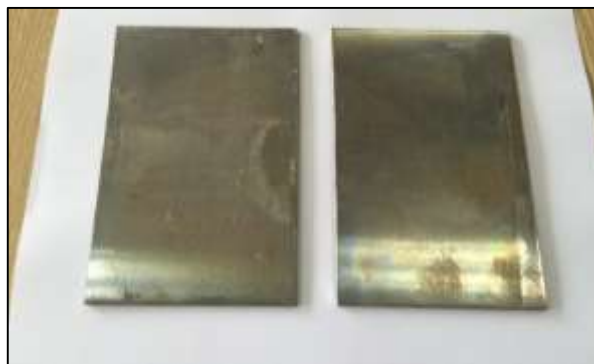
Figura 2.8. Planchas de aluminio AA6063 durante envejecimiento natural a T4.
