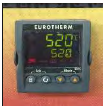
Figura 2.4. Temperatura de 520 °C programa en el interior del horno para el tratamiento.
