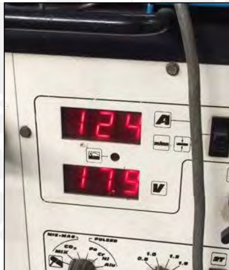
Figura 2.10. Parámetros de voltaje e amperaje durante el soldeo.
