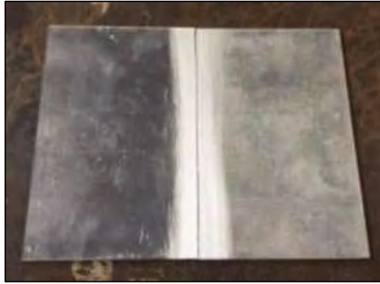
Figura 2.16. Planchas luego de la limpieza de bordes.
