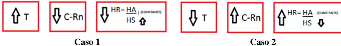
**Figura 1.26: Esquema de la influencia de la temperatura (T) en la concentración de Radón (C-Rn), a una humedad absoluta constante (Ha) y humedad de saturación (Hs) que varía con la temperatura.**
