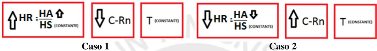
**Figura 1.29:** Esquema de la influencia de la humedad relativa (HR) en la concentración de Rn-222 (C-Rn), a una humedad de saturación (HS) y temperatura (T) constantes.
