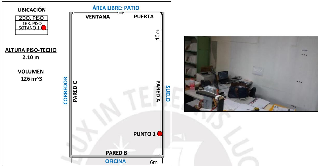
Figura 3.27: (a) Diseño y punto de medición del lugar de trabajo 8A. (b) Punto de medición
