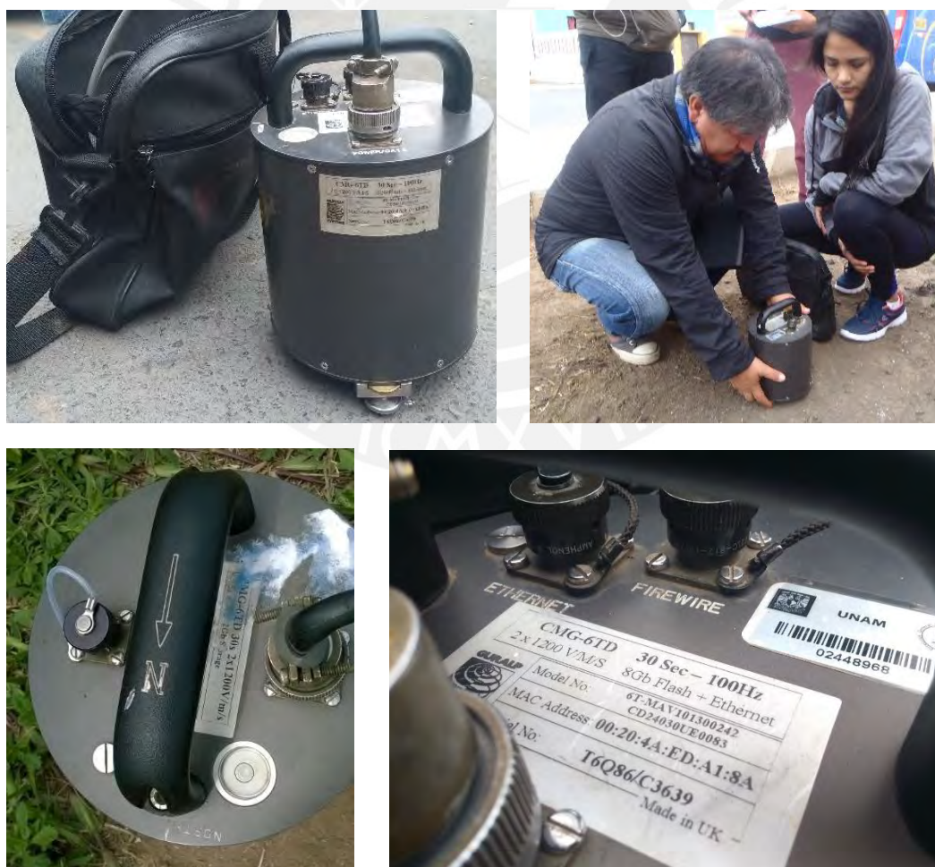
Figura 3.4. Sismómetro GURALP para registrar vibraciones ambientales.
