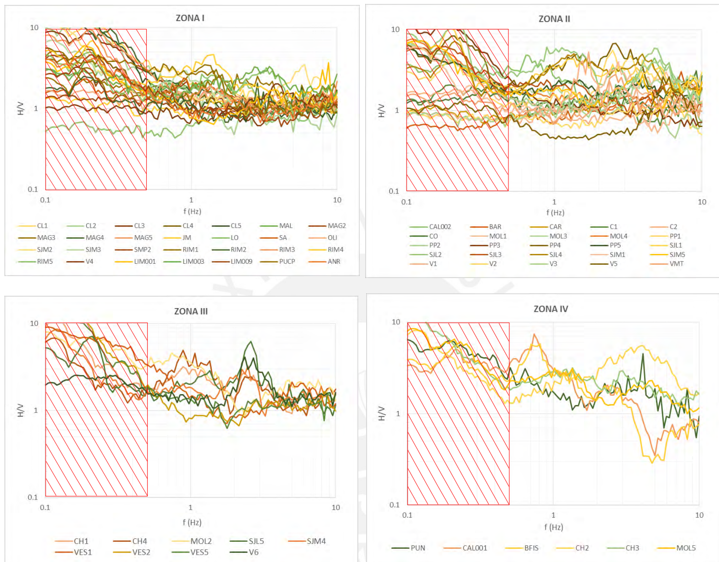
Figura 3.9. Funciones de Transferencia Empírica de ruido ambiental en Lima agrupadas según la microzonificación elaborada por CISMID (2016).
