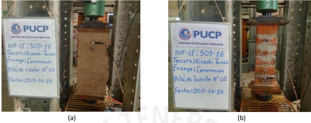
Figura 2.1. Ensayo de compresión en (a) prismas de adobe y (b) prismas de ladrillo artesanal.
