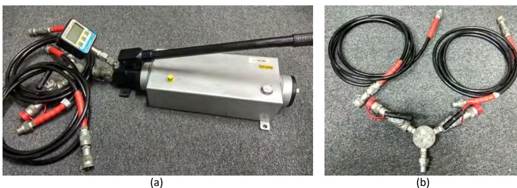
Figura 1.2. Sistema de bombeo (a) Bomba de presión hidráulica y (b) Bypass y mangueras de conexión.
