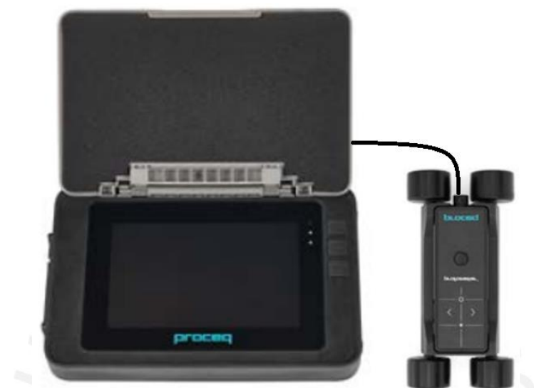
Figura 25: Equipo de detector de barras de acero
