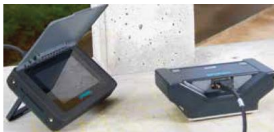
Figura 24: Equipo de pulso eco (Ondas S)
