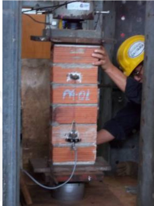
Figura 4.3. Pila instalada para ensayo
