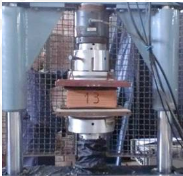
Figura 3.5. Ensayo de compresión
