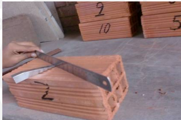
Figura 3.3. Ensayo de Alabeo
