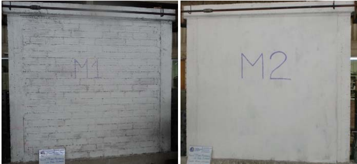
Figura 8.3. Izquierda, Muro tradicional (M1) – Derecha, Muro enmallado (M2) – Fase 2
