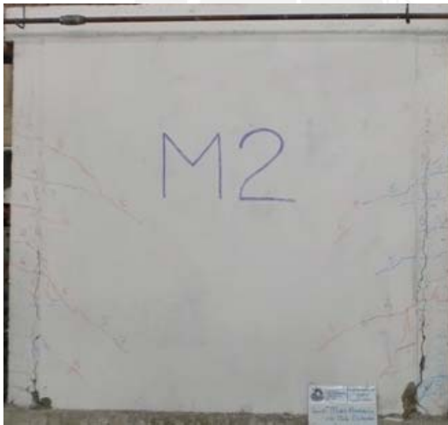
Figura 8.31. Muro con Refuerzo M2 – Movimiento Armónico
