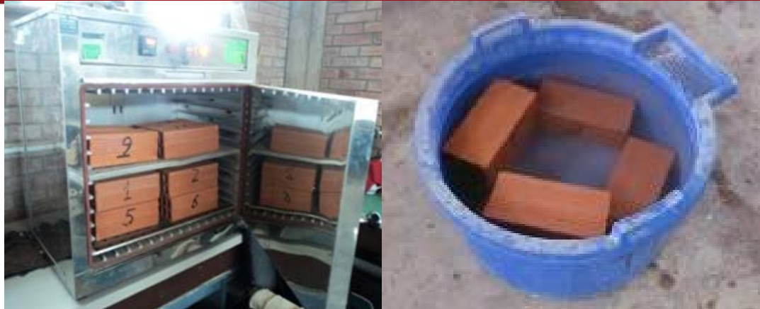
Figura 3.7. Ensayo de Absorción, Izquierda: Unidades almacenadas en el horno. Derecha: Unidades en un recipiente con agua.
