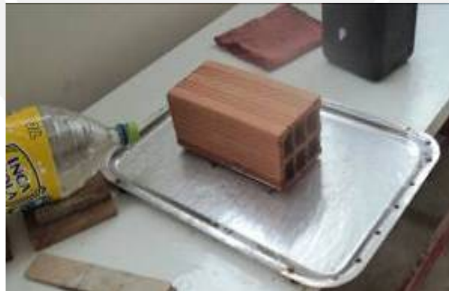
Figura 3.6. Ensayo de Succión
