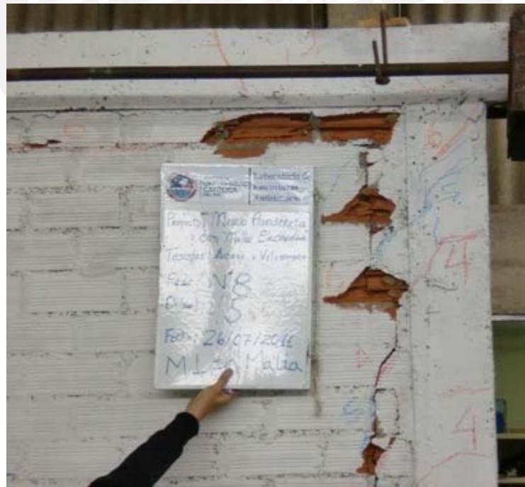
Figura 8.22. Trituración de ladrillos en M1
