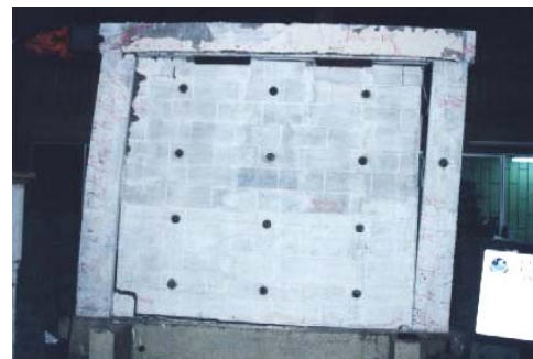
Figura 12.1. Comportamiento de separación entre el tabique y el pórtico (Ref.2)
