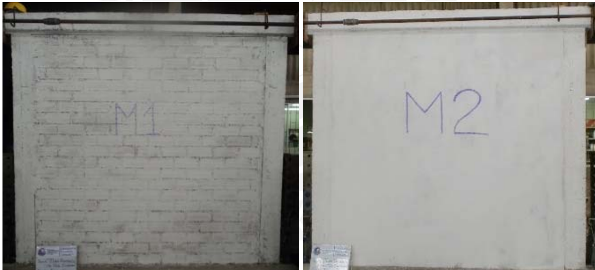
Figura 8.2. Izquierda, Muro Tradicional (M1) – Derecha, Muro enmallado (M2) – Fase 1
