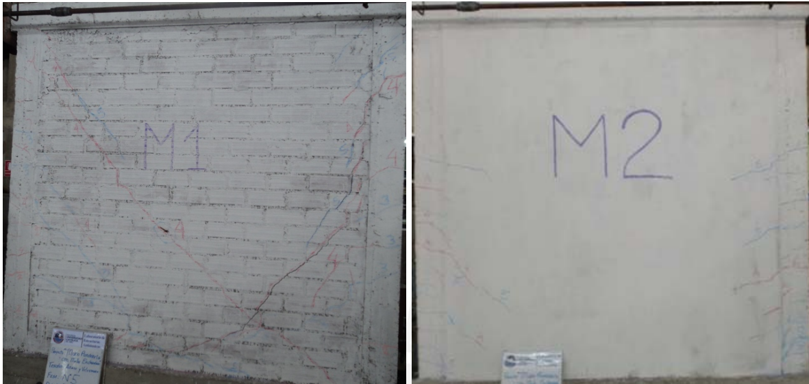
Figura 8.11. Izquierda, Muro Tradicional (M1) – Derecha, Muro enmallado (M2) – Fase 5
