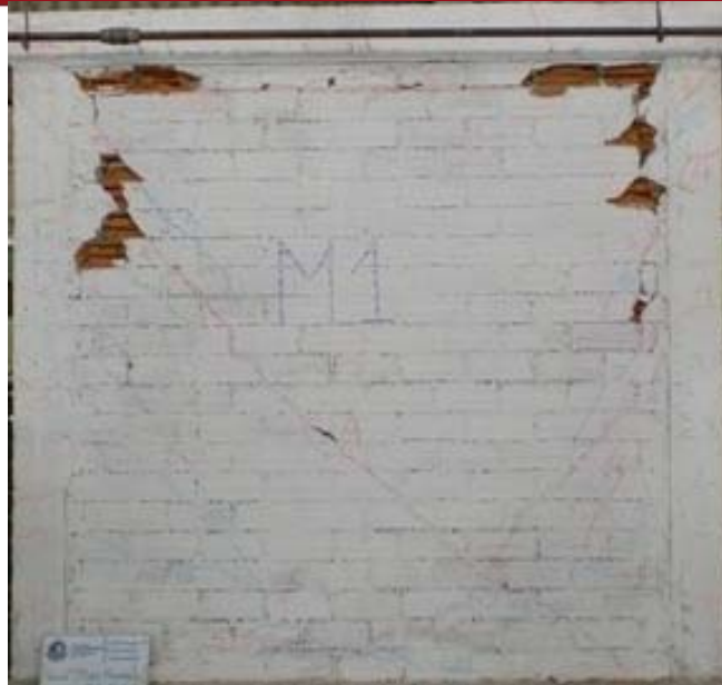
Figura 8.30. Muro M1 al terminar la fase armónica.
