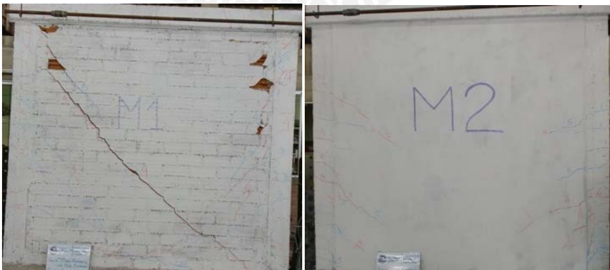
Figura 8.14. Izquierda, Muro Tradicional (M1) – Derecha, Muro enmallado (M2) – Fase 6
