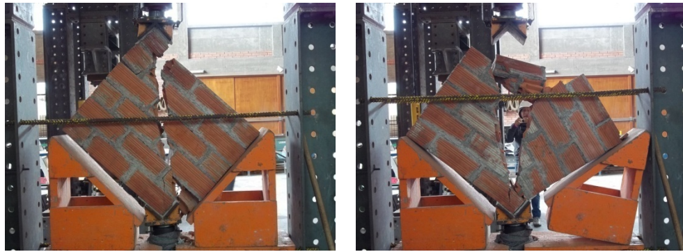
Figura 4.13. Forma de falla de los muretes 3 y 4.
