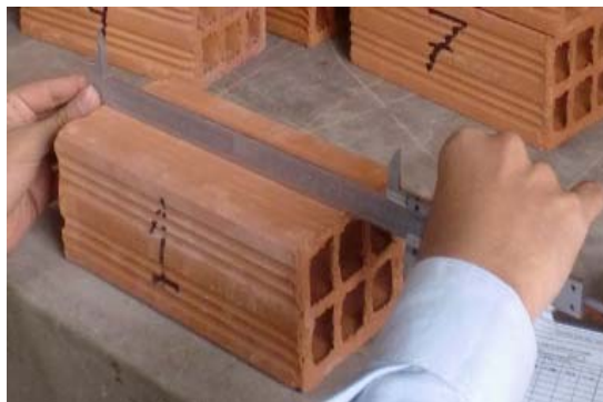
Figura 3.2. Ensayo de Variación Dimensional
