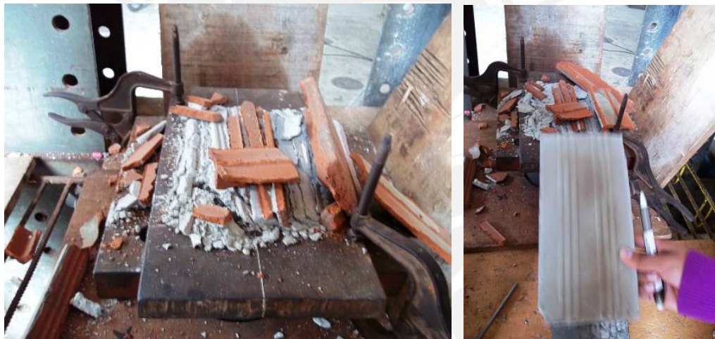
Figura 4.4. Falla del capping por trituración en la base de la pila PA-04
