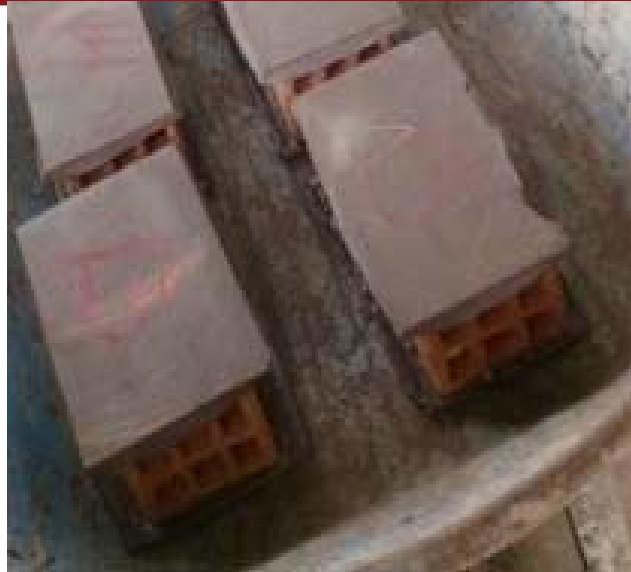
Figura 3.4. Ladrillo con capping, listo para ensayar
