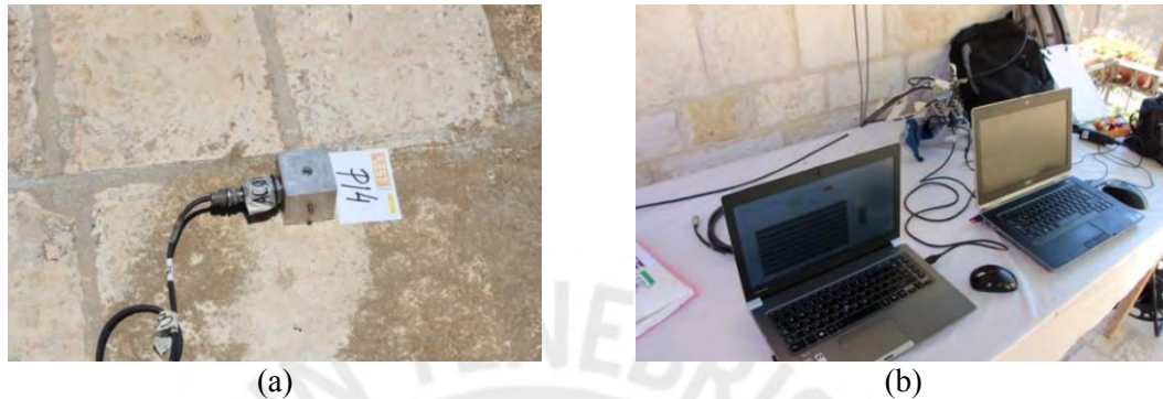
Figura 15. Identificación modal del HSJ: (a) acelerómetro adherido a la estructura mediante un bloque y (b) equipo de adquisición y registro de datos.
