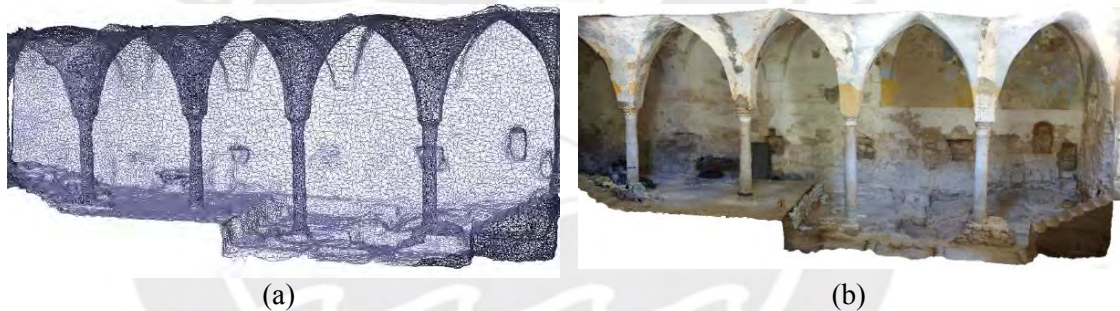
Figura 6. Reconstrucción 3D del interior del HSJ: (a) malla 3D y (b) malla texturizada.
