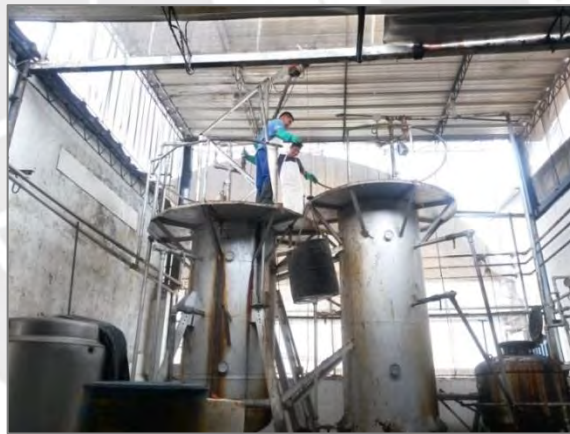
Ilustración 2.3 Carga de la marmita Fuente: La empresa. Elaboración Propia
